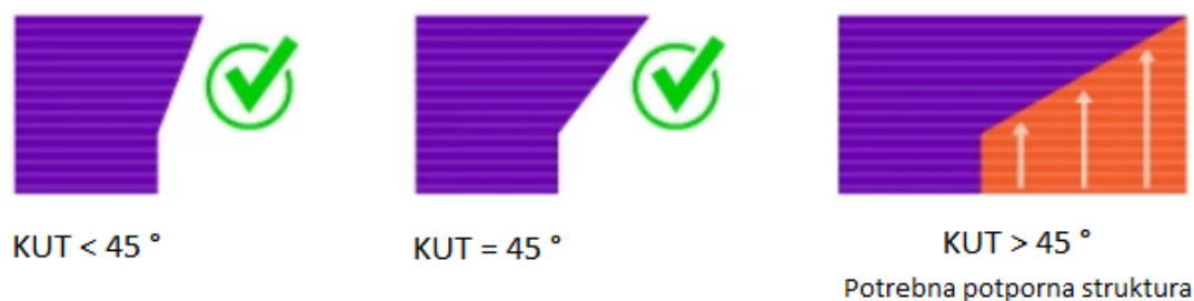
Slika 27. Samonosivi kut za aditivnu proizvodnju [20]
