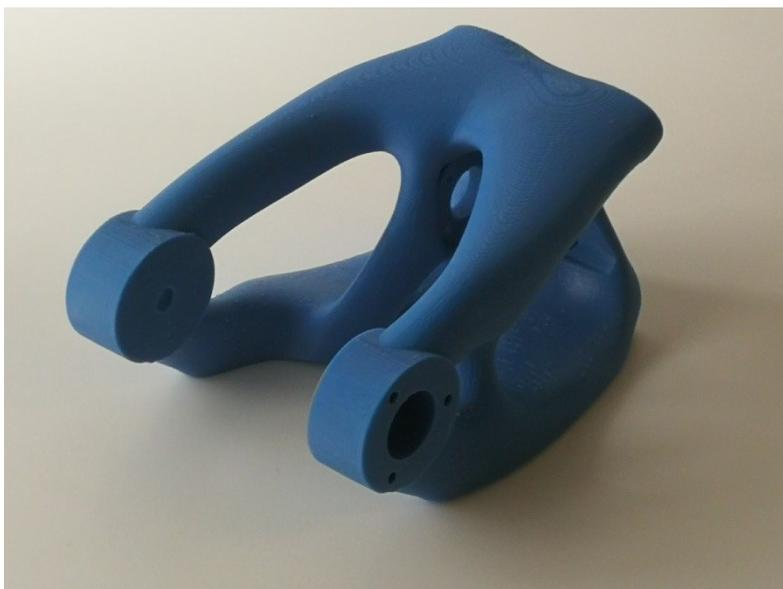
**Slika 47. Proizvod nakon uklanjanja potporne strukture**
