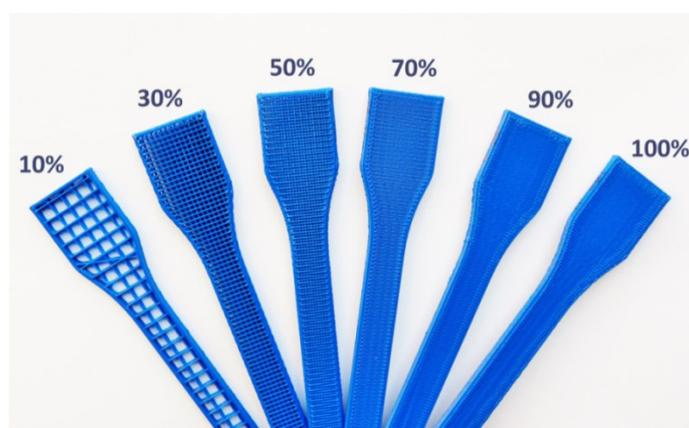
Slika 24. Različiti postotci ispune poprečnog presjeka [17]
