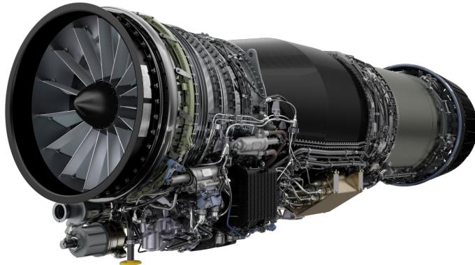
Slika 4.1: Turbomlazni motor SNECMA M-88 [10]
