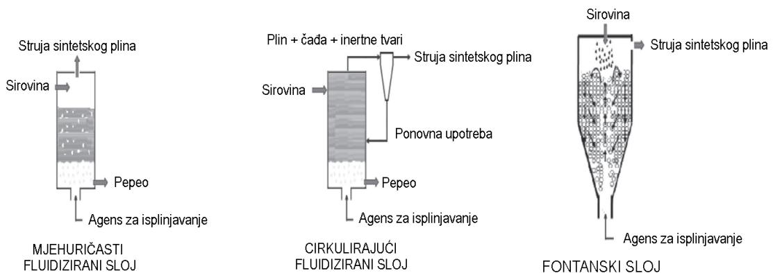
Slika 9. Sheme isplinjača s fluidiziranim (lijevo i sredina) i fontanskim slojem (desno) [42]
