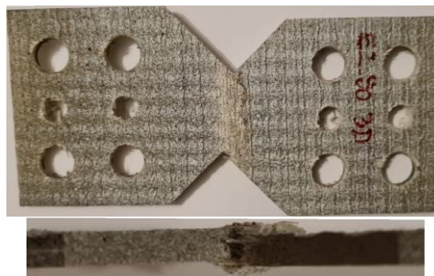
Slika 52. Ispitni uzorka nakon zadnjeg ciklusa monotonog ispitivanja.
