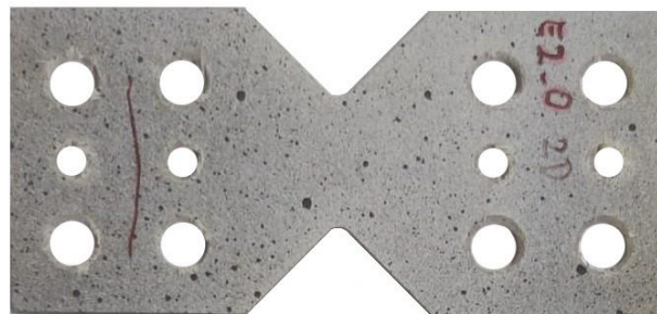
Slika 13. Ispitni uzorak s nanesenim stohastičkim crno-bijelim rasterom.
