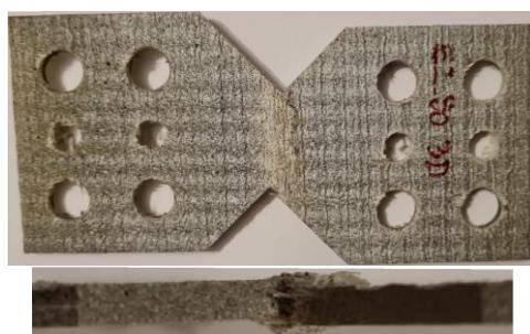
**Slika 52. Ispitni uzorka nakon zadnjeg ciklusa monotonog ispitivanja.**
