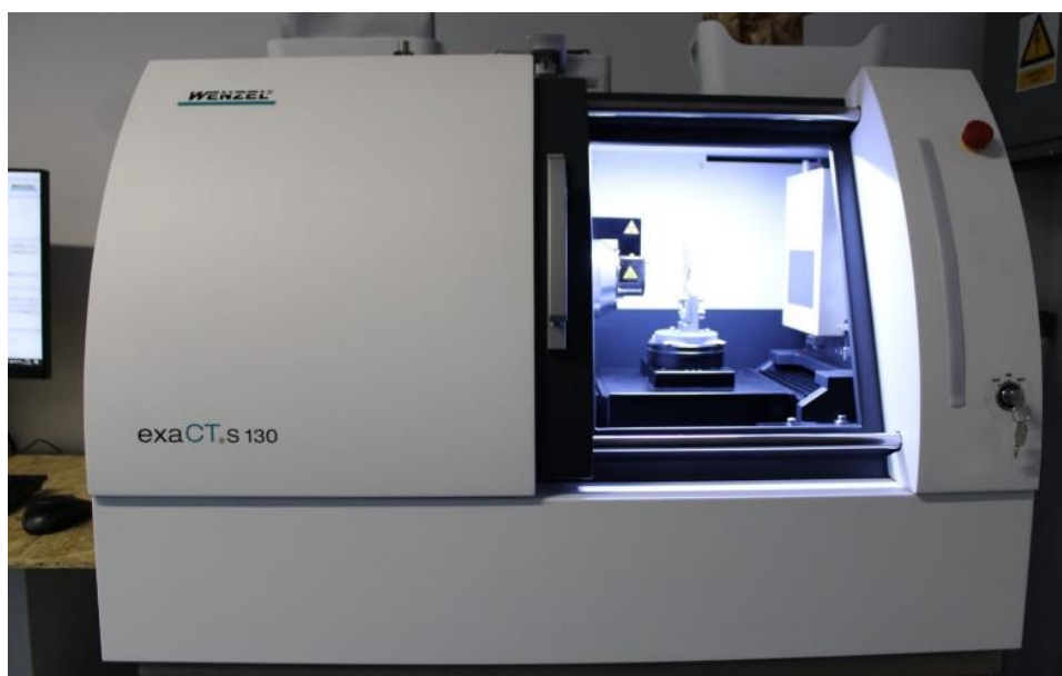
Slika 14. Računalni tomograf WENZEL® exaCT ®s 130 tvrtke Neo Dens d.o.o.
