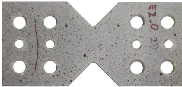
Slika 13. Ispitni uzorak s nanesenim stohastičkim crno-bijelim rasterom.
