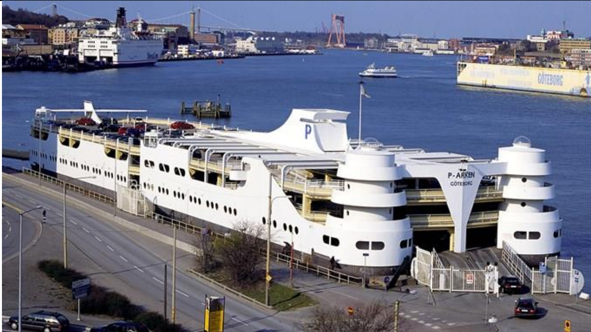
Slika 2. Prikaz plutajućeg garažnog objekta tvrtke MacGregor [3]
