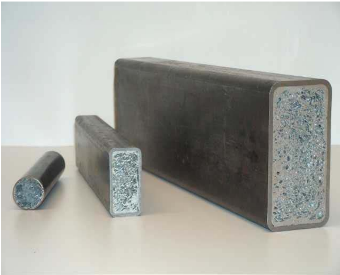
Slika 2. Sendvič konstrukcija s jezgrom od metalne pjene [2]
