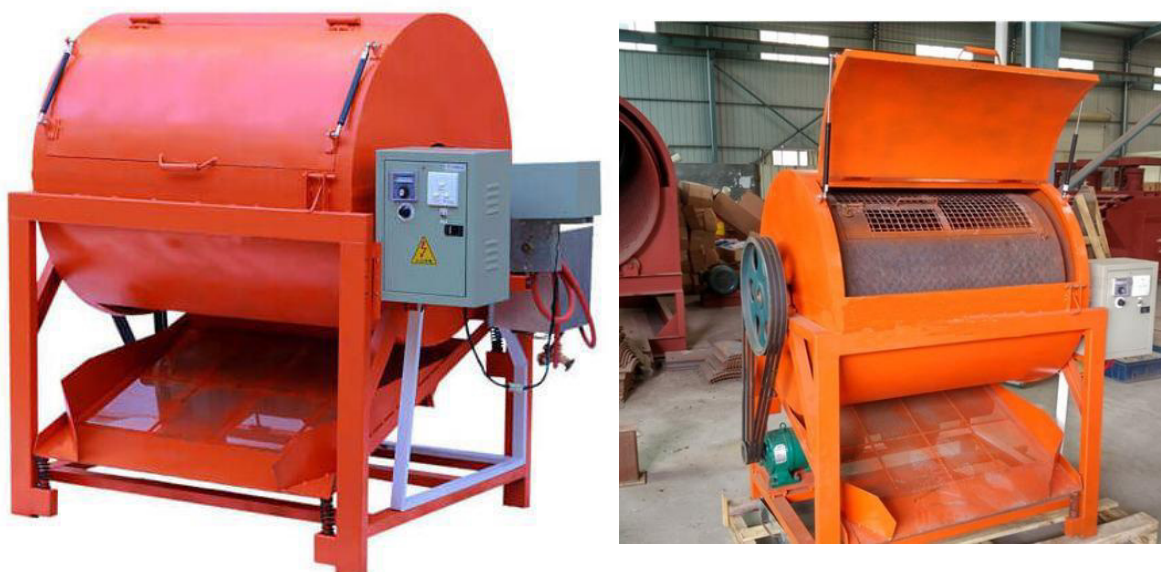
Slika 47. Stroj za uklanjanje komponenti s matičnih ploča
