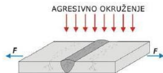
Slika 22. Čimbenici koji uvjetuju nastanak napetosne korozije [36]
