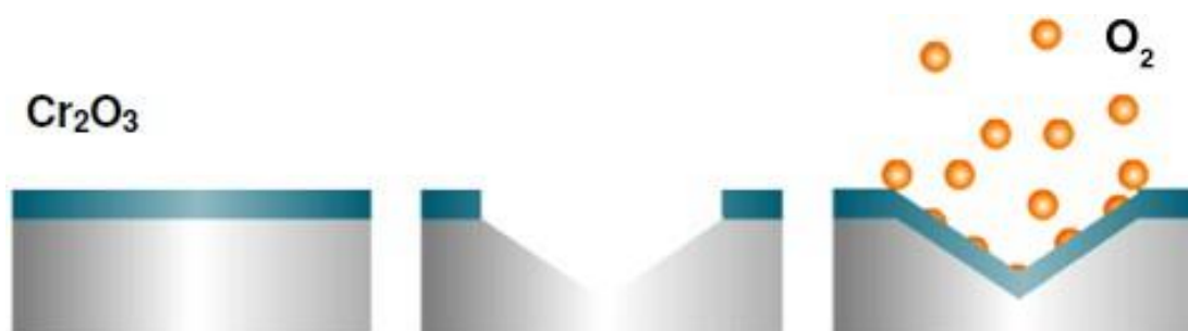
Slika 1. Prikaz mehanizma samoobnavljanja pasivnog filma [6]
