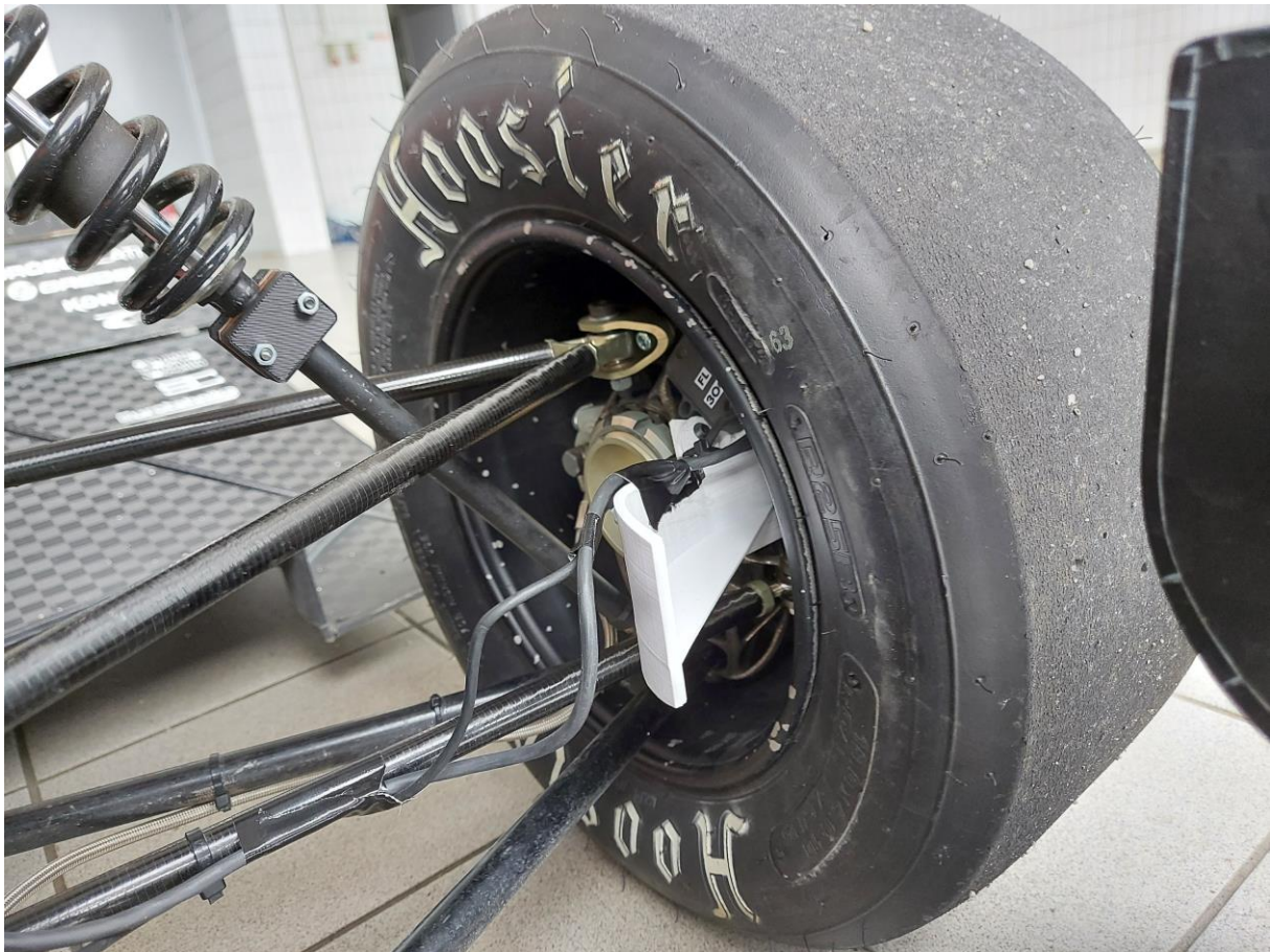
Slika 28. Prednji sklop kotača s IC senzorom i aerodinamičkim deflektorom za hlađenje diskova
