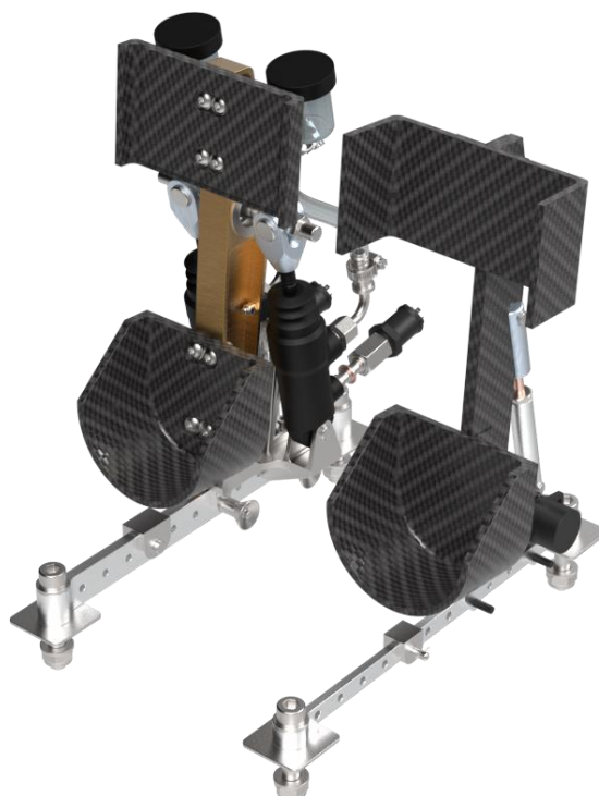
Slika 16. Sklop pedala bolida FSB-RT06R VulpesR -a
