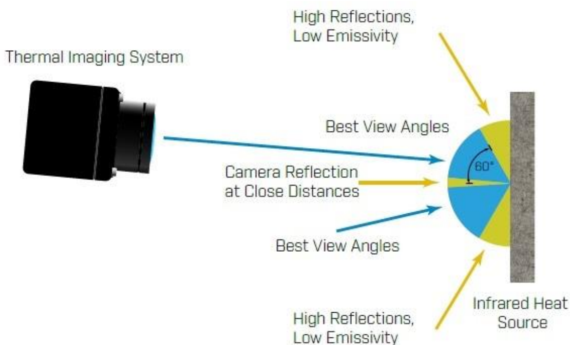
Slika 23. Optimalan kut mjerenja IC senzorom [22]
