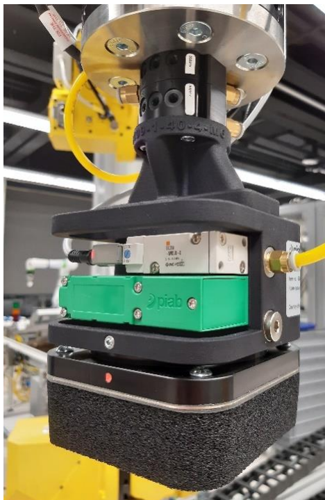
Slika 11. Piab Kenos KCS vakuumska hvataljka
