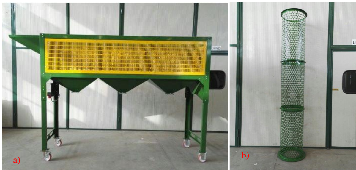
Slika 32 Kalibrator s bubnjem s povećavajućim promjerima rupa a) cijeli stroj b) bubanj [13]
