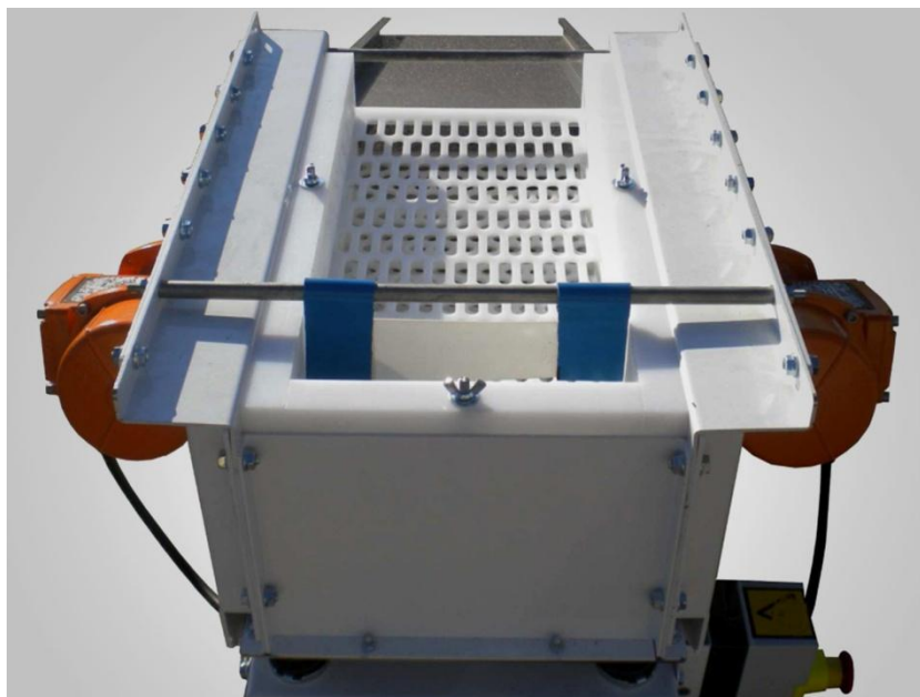
Slika 47 Vibracijski stol za grubo odvajanje ljuski [17]
