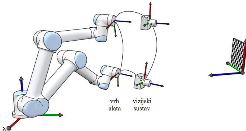
**Slika 3. Eye-in-hand kalibracija vizijskog sustava naspram vrha alata [5]**
