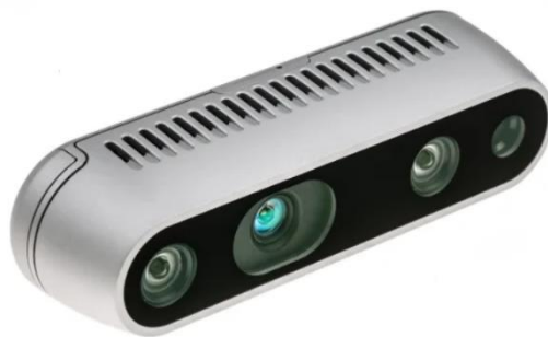
Slika 7. Stereovizijski sustav Intel RealSense D435 [8]
