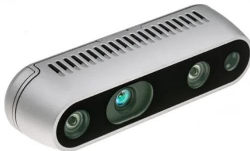
**Slika 7. Stereovizijski sustav Intel RealSense D435 [8]**
