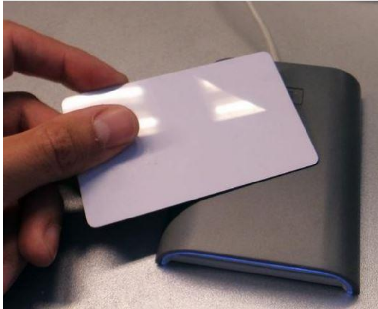
Slika 26. RFID kartica i čitač [227]
