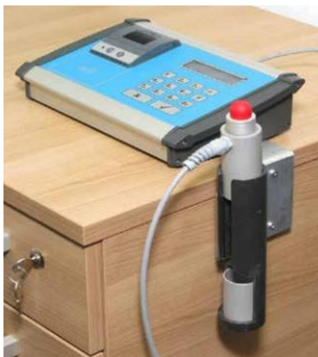
Slika 29. Uređaj KALI1 za mjerenje vrelišta kočne tekućine s mogućnošću RFID načina prijenosa podataka [228]
