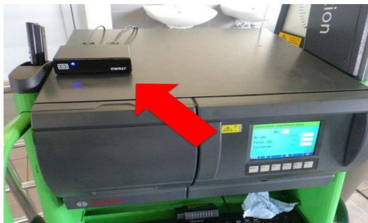
Slika 28. RFID uređaj postavljen na analizator ispušnih plinova [227]
