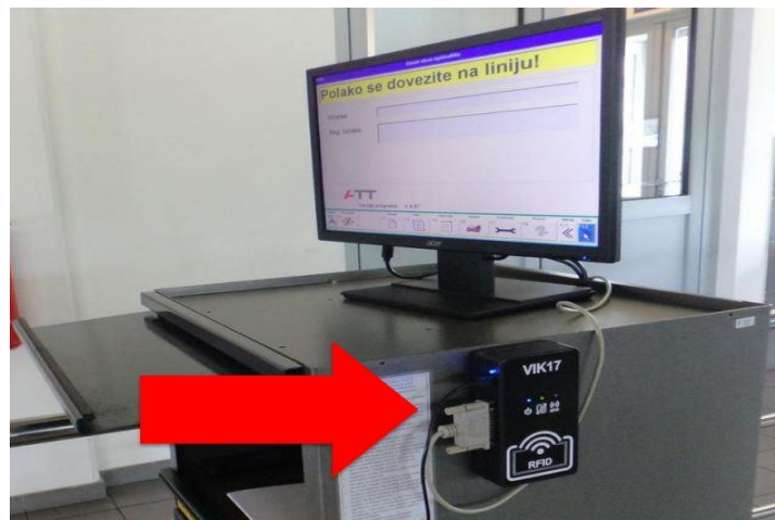
Slika 27. RFID uređaj postavljen na uređaj za mjerenje sila kočenja [227]
