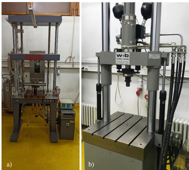
Slika 34. Prikaz a) kidalice Beta 50-5; b) umaralice LFV 50-HH
