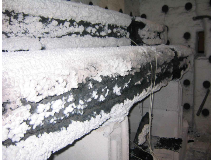
Slika 7. Izgled čeličnih profila nakon hlađenja
