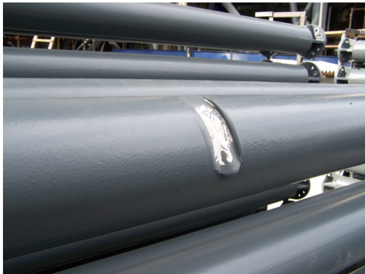
Slika 4. Oštećenje premaza pri transportu
