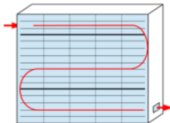
Slika 30. Smjer strujanja rashladne tekućine u hladnjaku
