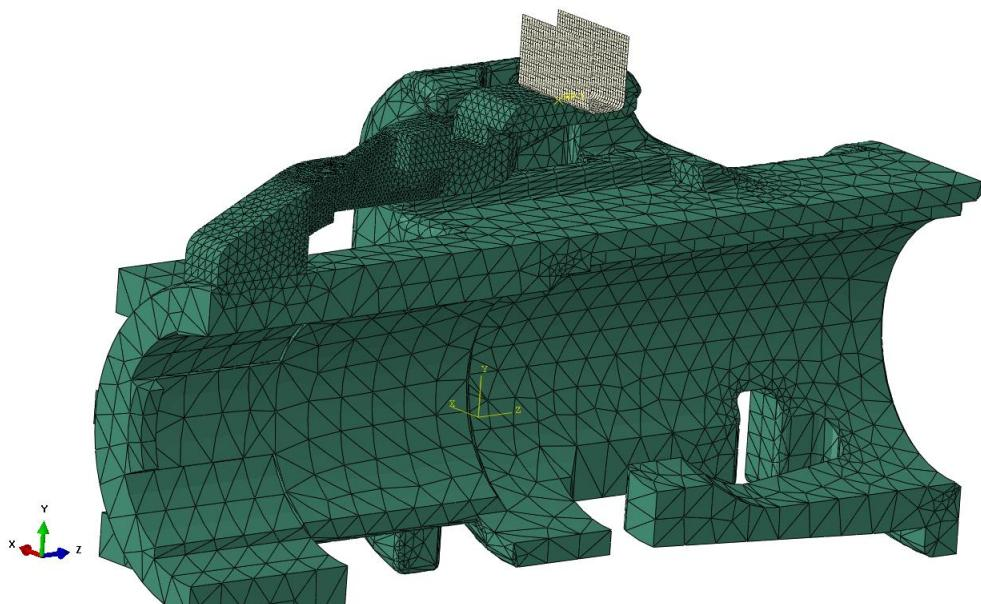
Slika 47. Podjela CAD modela na konačne elemente
