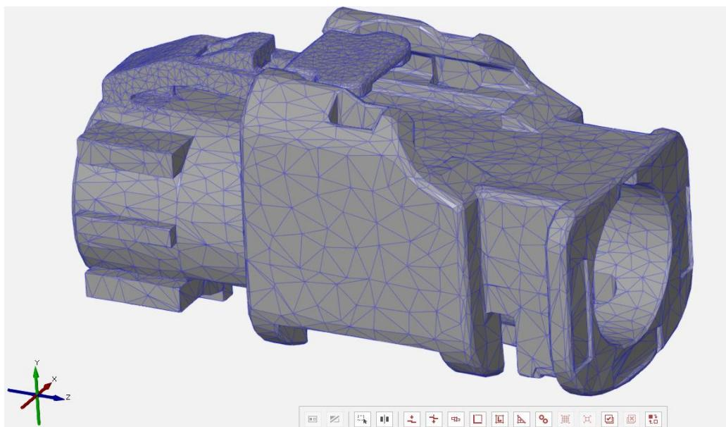
**Slika 57. Pojednostavljeni mreži površina realnog kućišta konektora**
