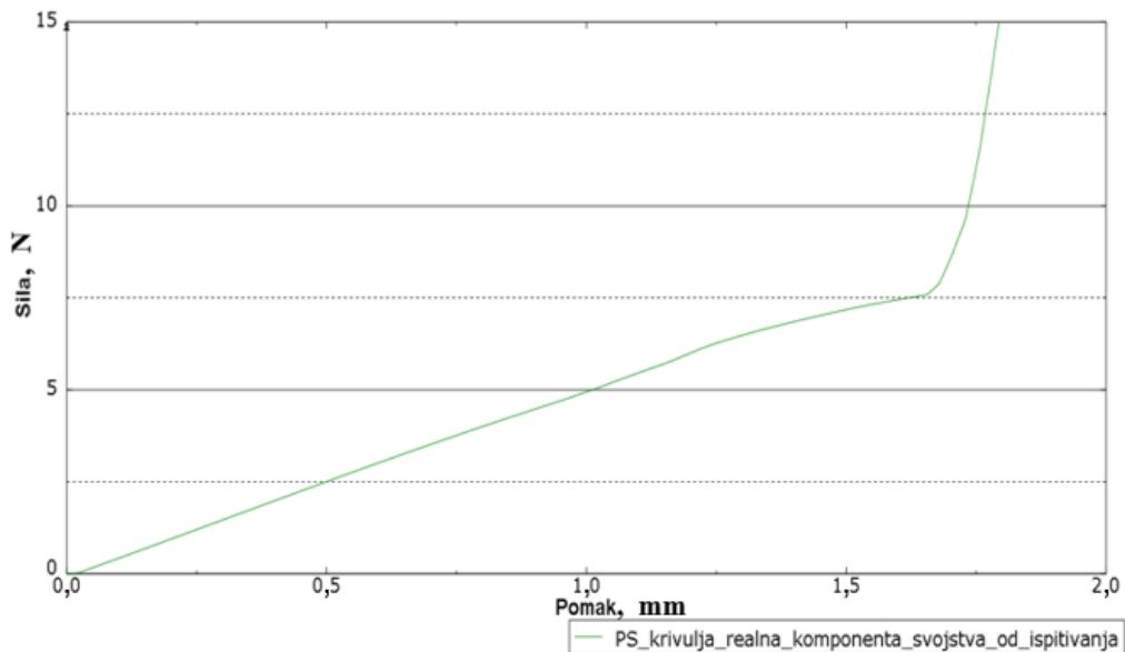
**Slika 69.** Dijagram ovisnosti sile o pomaku slobodnog kraja kopče za zaključavanje za analizirani realni model kućišta sa svojstvima materijala dobivenim eksperimentalnim mjerjenjem
