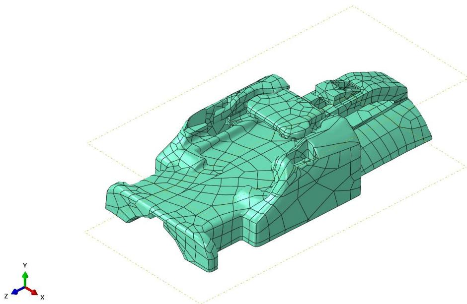
**Slika 60. Pojednostavljeni realni računalni model kućišta električnog konektora unešenog u programski paket Abaqus**
