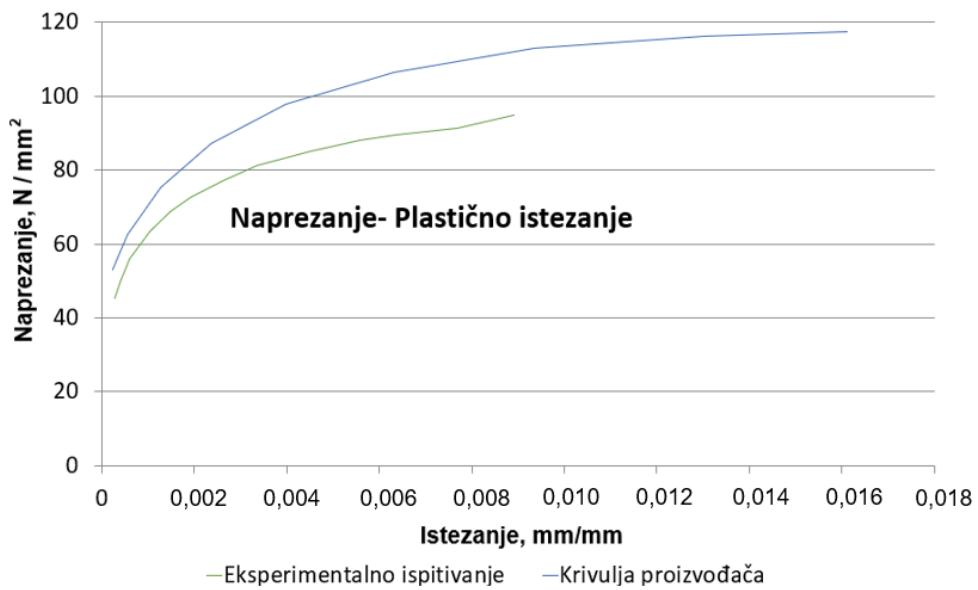
**Slika 25. Dijagram naprezanje – plastična deformacija za Pocan B3225**
