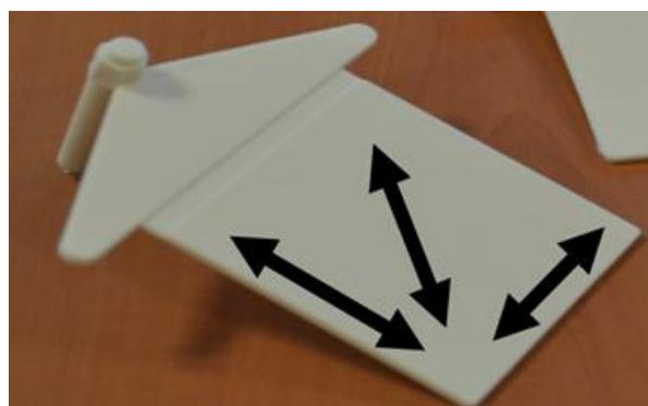
Slika 12. Kompozitna pločica izrađena od materijala Pocan B3225 [11]
