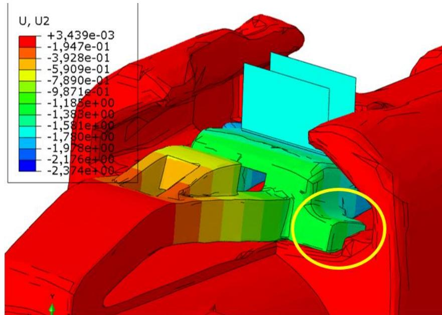
**Slika 64.** Detalj kućišta konektora na mjestu kopče - raspodjela pomaka u pravcu osi Y, mm na deformiranim obliku kućišta (svojstva materijala dobivena od proizvođača materijala)
