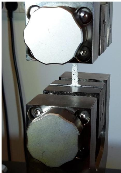
Slika 17. Provođenje statičkog vlačnog ispitivanja materijala Pocan B3225 [11]
