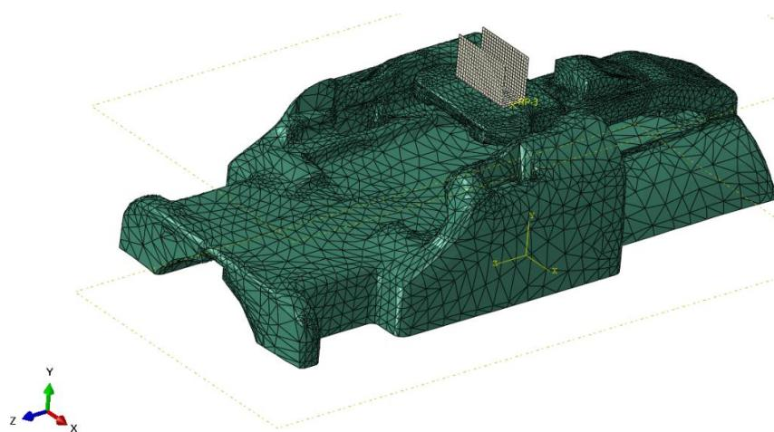
**Slika 62. Podjela modela kućišta na konačne elemente**
