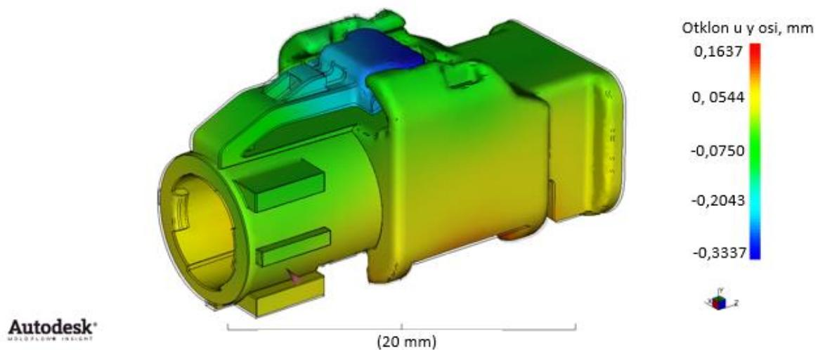
**Slika 73. Prikaz iskrivljjenja (u mm) kopče za zaključavanje prilikom brizganja u smjeru Y osi pomoću programskog paketa Moldflow**
