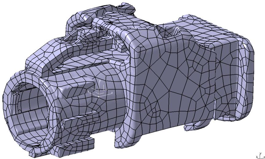
**Slika 55. CAD model geometrije kućišta električnog konektora**
