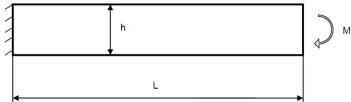
Slika 35 Geometrija konzole opterećene na čisto savijanje s momentom na slobodnom kraju [23]
