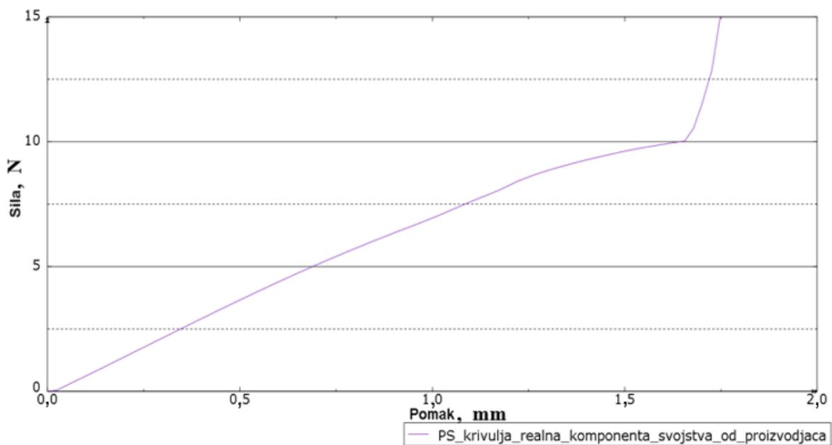
**Slika 66. Dijagram ovisnosti sile o pomaku slobodnog kraja kopče za zaključavanje za analizirani realni model kućišta sa svojstvima materijala preuzetih od proizvođača**
