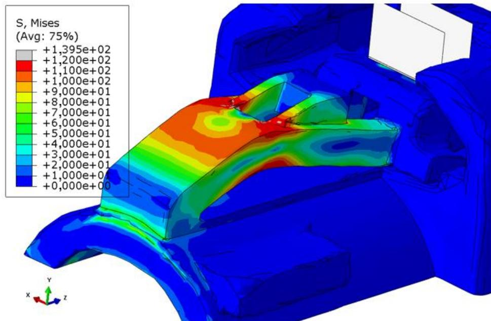
**Slika 65.** Raspodjela ekvivalentnog naprezanja prema von Misesu ( $N/mm^2$ ) na deformiranim obliku kopče za zaključavanje (svojstva materijala dobivena od proizvođača materijala)
