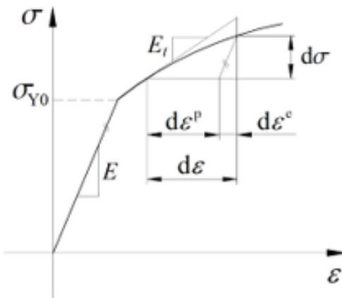
Slika 29. Prirast naprezanja  $d\sigma$  za prirast deformacije  $d\varepsilon$  [21]
