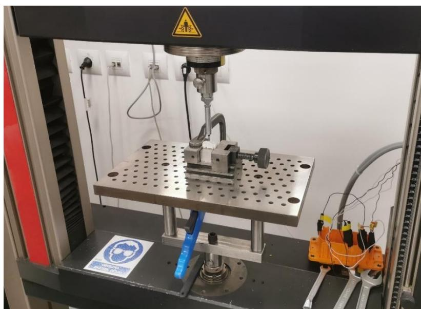
**Slika 41. Postav na kojemu su provedena eksperimentalna ispitivanja kućišta električnog konektora**
