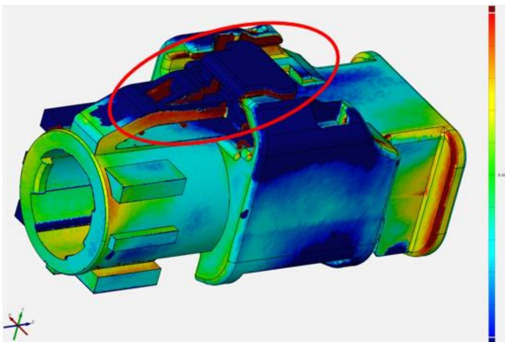
**Slika 72.** Preklapanje realnog računalnog modela kućišta konektora s CAD modelom pomoću programskog paketa GOM Inspect
