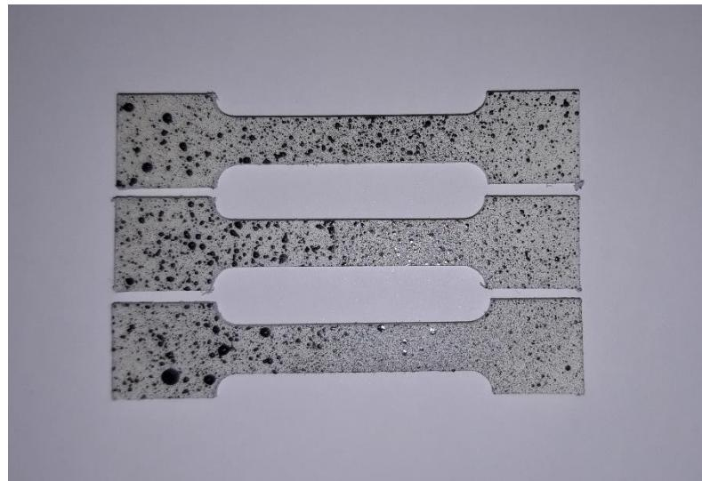
**Slika 15. Pripremljene epruvete**
