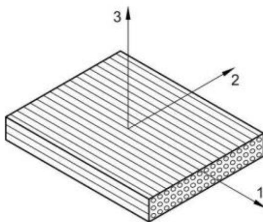
**Slika 10. Transverzalno izotropni materijalni model s pripadnim osima [12]**
