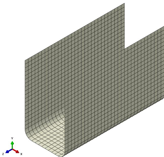
Slika 48. Podjela površine ticala na konačne elemente
