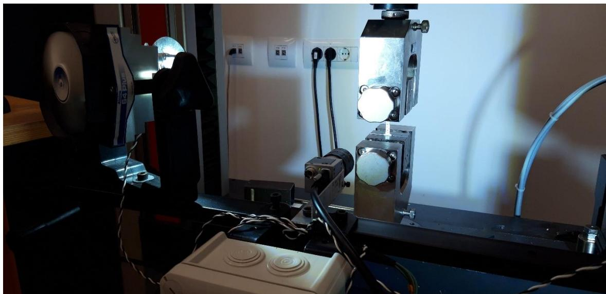
**Slika 16. Ispitna konfiguracija za statički vlačni test**
