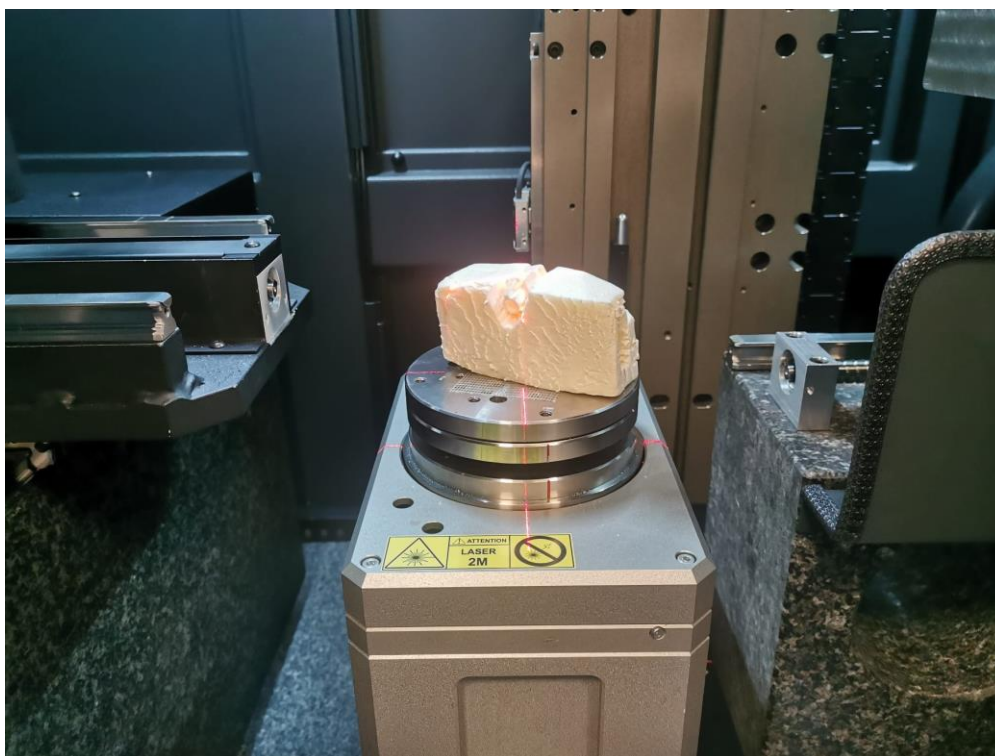
Slika 8. Prikaz pozicioniranog kućišta električnog konektora u CT uređaju
