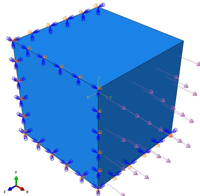
**Slika 32. Primjenjeni rubni uvjeti i opterećenje u smjeru vlakana na jednom konačnom elementu sa svojstvima materijala dobivenih eksperimentom**
