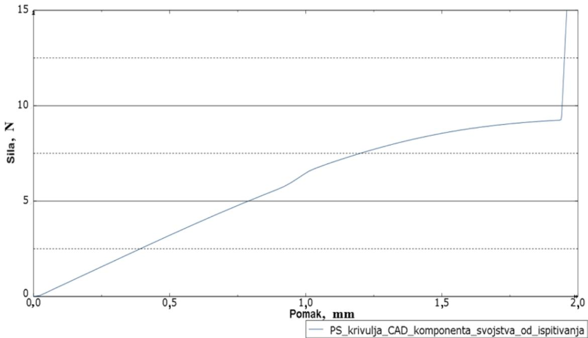
**Slika 54.** Dijagram ovisnosti sile o pomaku slobodnog kraja kopče za zaključavanje za analizirani CAD model sa svojstvima materijala dobivenim eksperimentalnim mjerjenjem
