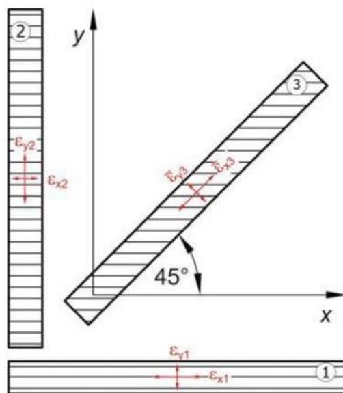
**Slika 13. Princip izrezivanja epruveta iz kompozitne ploče [11]**
