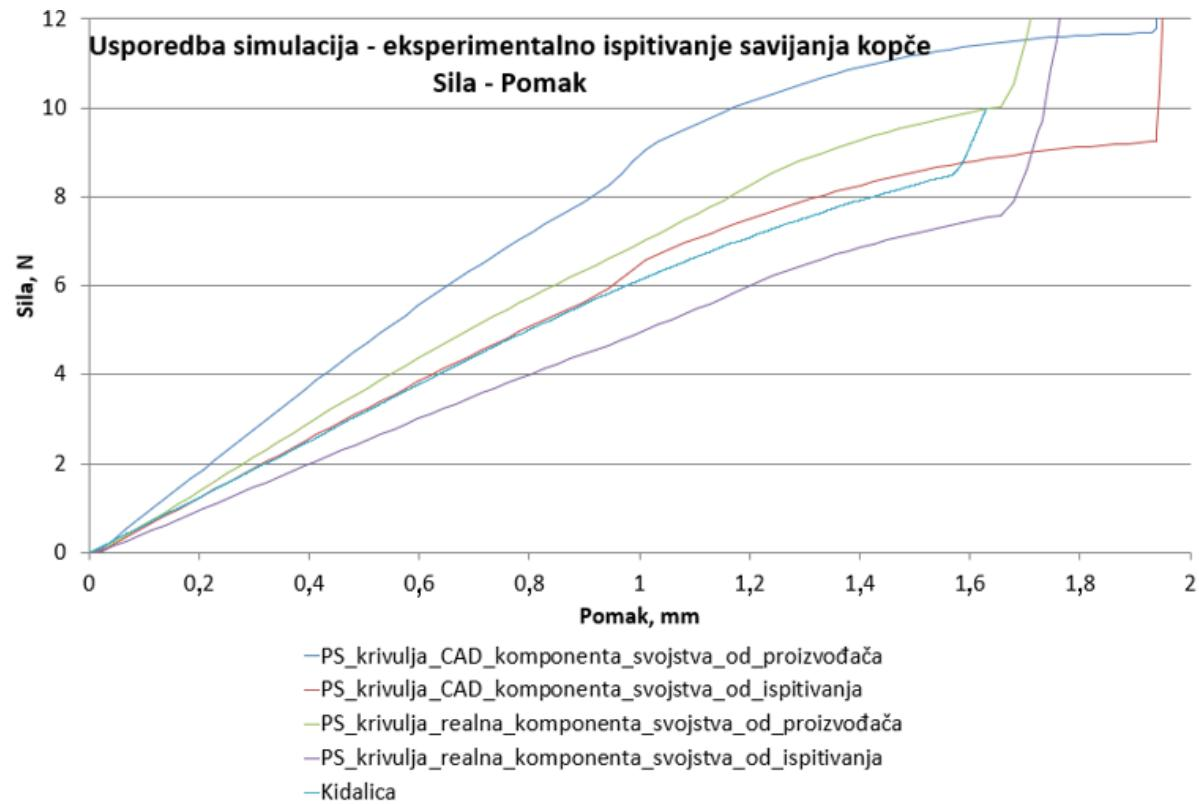
**Slika 71.** Usporedba dijagrama ovisnosti sile o pomaku slobodnog kraja kopče za zaključavanje dobivena s četiri analizirana numerička modela s eksperimentalnim mjeranjima
