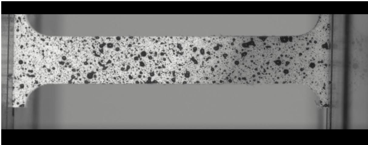
**Slika 18. Određivanje pomaka točaka primjenom DIC metode**
