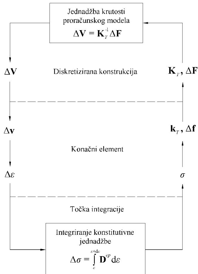
Slika 31. Postupak rješavanja nelinearnog statičkog problema primjenom metode konačnih elemenata [21]
