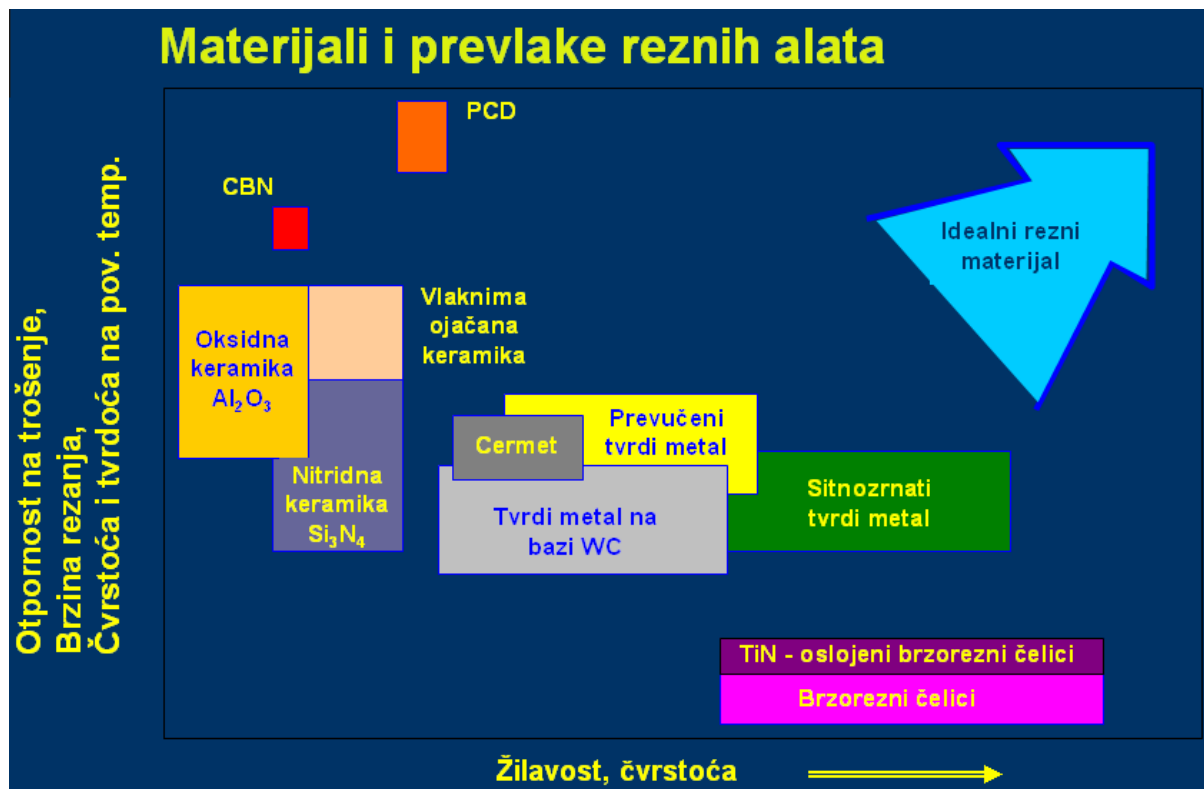
Slika 4. Materijali i prevlake reznih alata [11]
