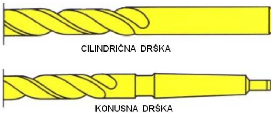
Slika 6. Podjela svrdla prema geometriji [12]
