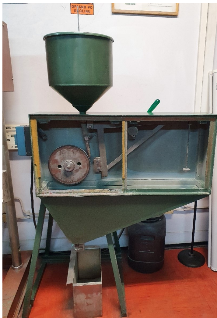
Slika 27. Uređaj za ispitivanje otpornosti na abrazijski mehanizam trošenja metodom „suhi pijesak – gumeni kotač“
