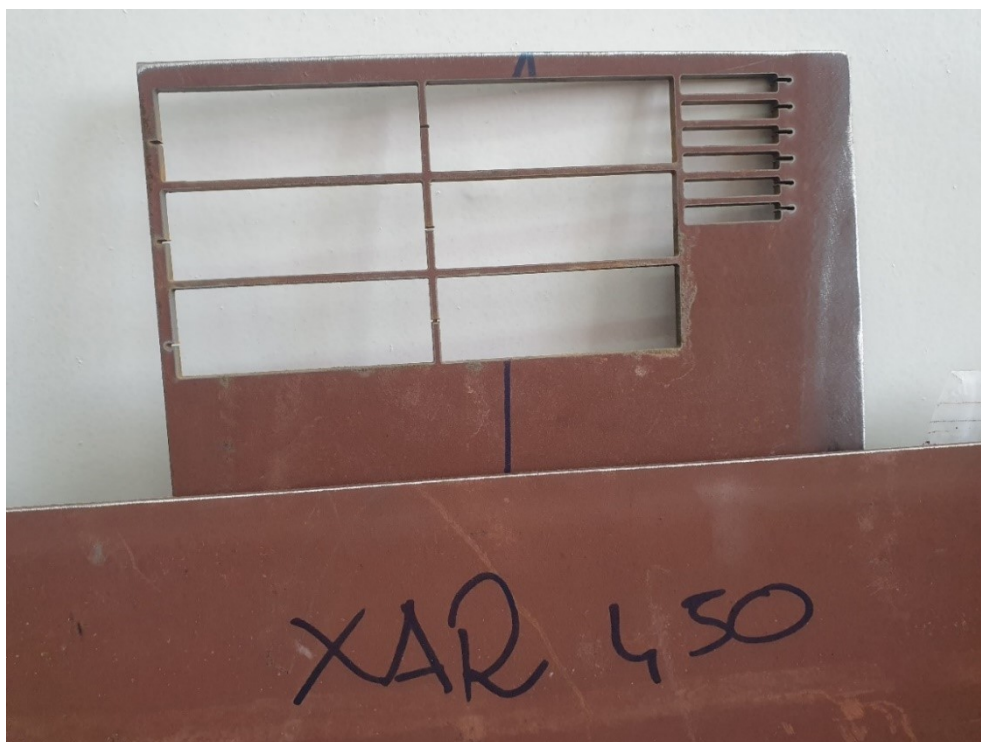
Slika 14. Mjesto izrezivanja uzoraka čelika XAR 450
