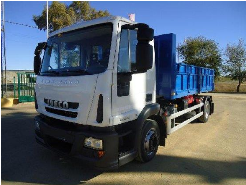
Slika 12. Trostrani kiper Iveco Eurocargo ML120 E25 [7]
