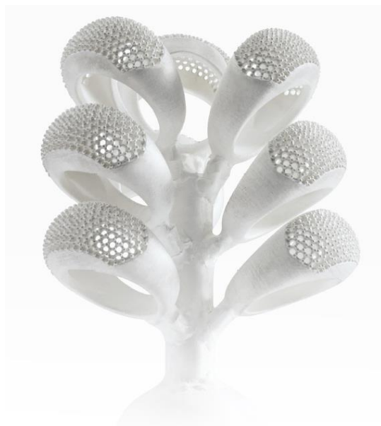
Slika 5.5. Primjer 3D ispisanih tvorevina spojenih na uljevni sustav za precizni lijev [24]
