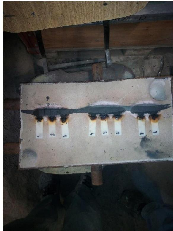
Slika 6.9.a. Nakon lijevanja metala i hlađenja
