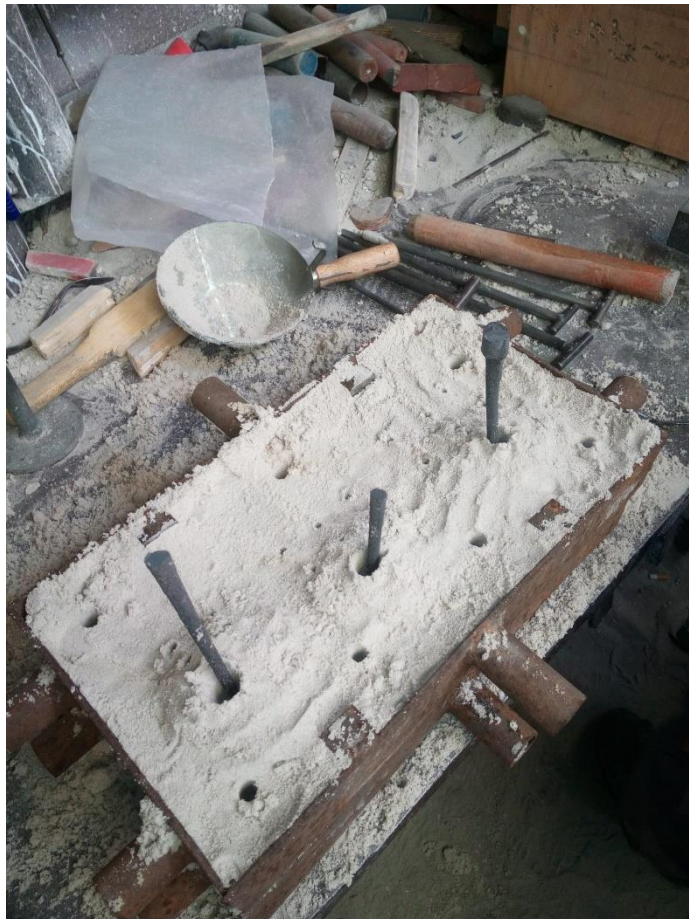
Slika 6.7. Postupak pješčanog lijeva u ljevaonici IMPK
