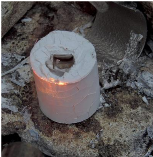
Slika 5.11. Zagrijani kalup u kojem je polimerna tvorevina rastaljena i kalupna šupljina napunjena rastaljenom mjedi [23]
