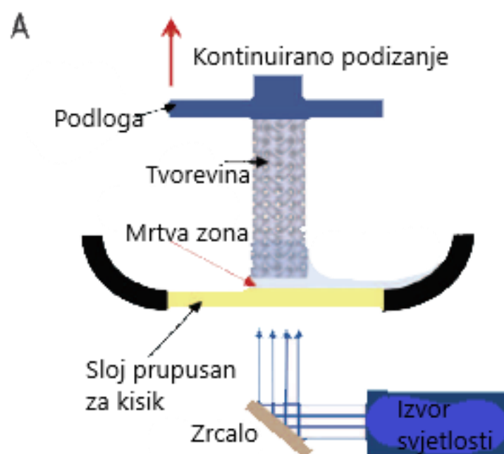
Slika 4.8. Shematski prikaz CLIP opreme [16]
