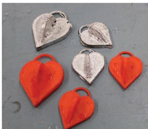
Slika 5.4. Prikaz mogućih nepravilnosti na spoju rebara i ostatka modela [23]
