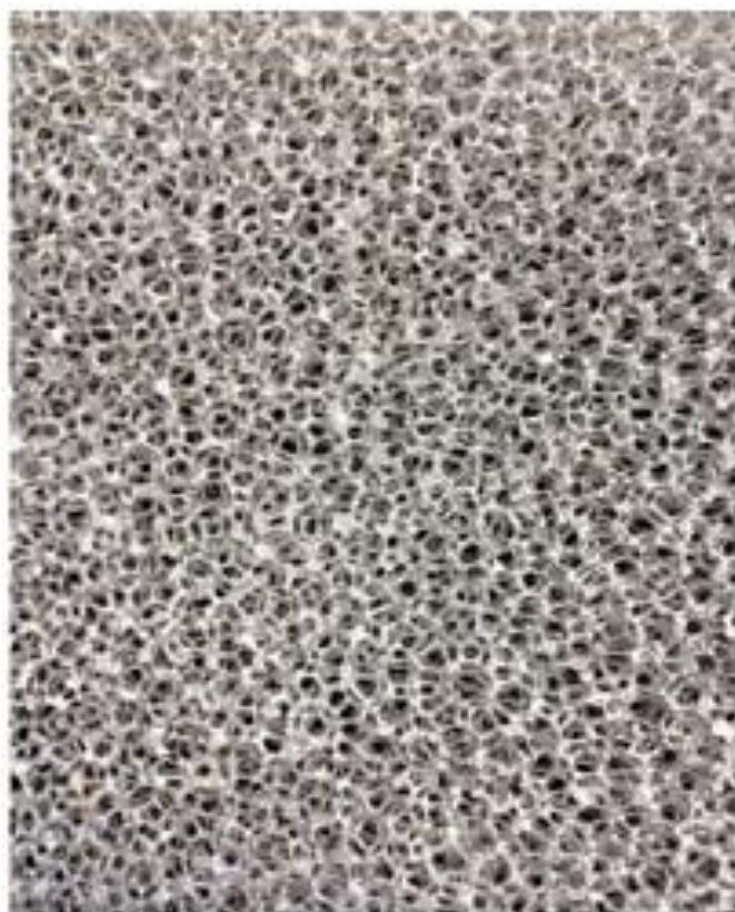
Slika 2.9.2 Prikaz mikrostrukture "ERG-Duocel" metalne pjene [6]
