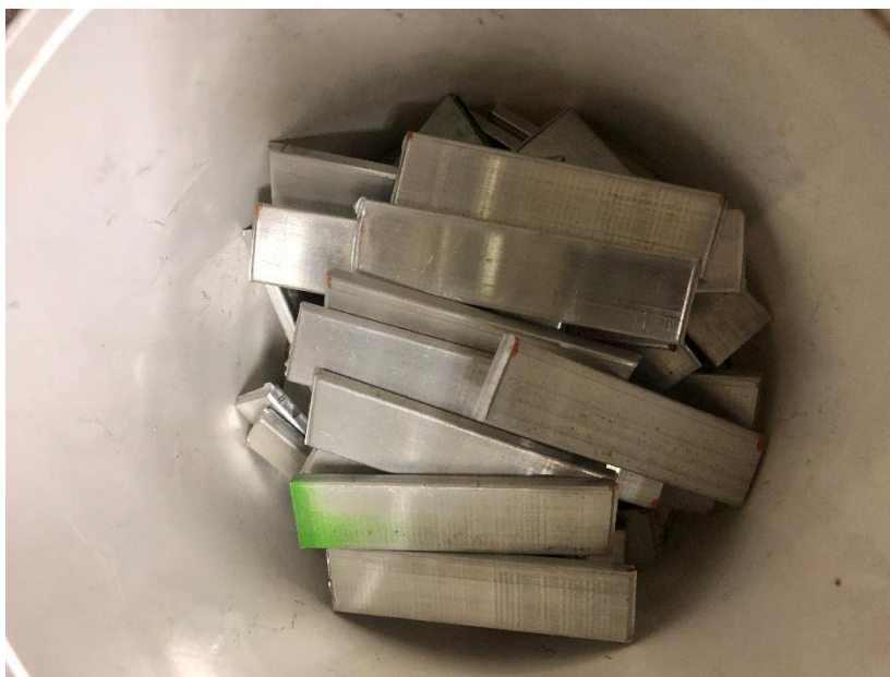
Slika 6.1.1 Korišteni prekursor sastava AlMgSi_{0,6} sa 0,4 mas % TiH_2
