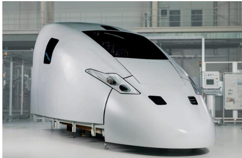
**Slika 4.7.1 Prednji dio konstrukcije vlaka izrađen od kompozitnog sendviča s jezgrom od aluminijeve pjene [14]**
