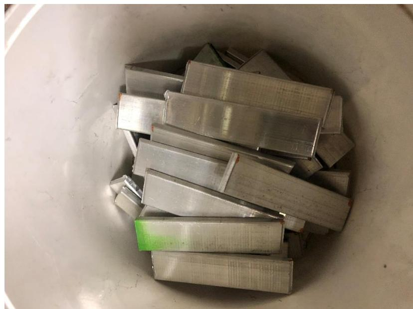
Slika 6.1.1 Korišteni prekursor sastava AlMgSi0,6 sa 0,4 mas %TiH<sub>2</sub>
