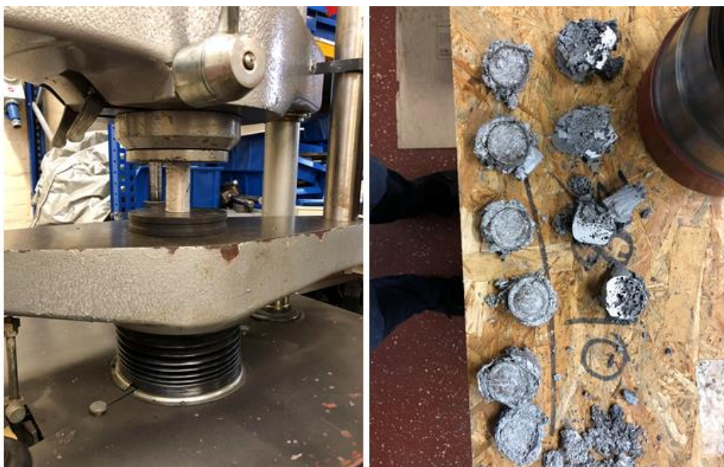
Slika 6.3.2 Postupak tlačnog ispitivanja i uzorci nakon ispitivanja
