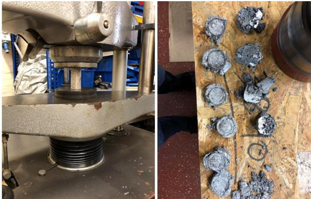
**Slika 6.3.2 Postupak tlačnog ispitivanja i uzorcni nakon ispitivanja**
