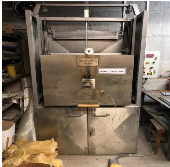
**Slika 6.1.5 Elektrootporna zvonasta peć**
