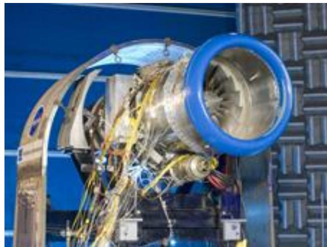
**Slika 4.4.1 Obloga zrakoplovnog motora od metalne pjene [12]**
