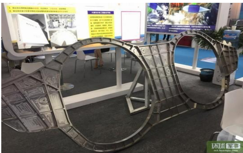
Slika 6. Okvir trupa zrakoplova proizveden tehnologijom selektivnog laserskog srašćivanja [10]
