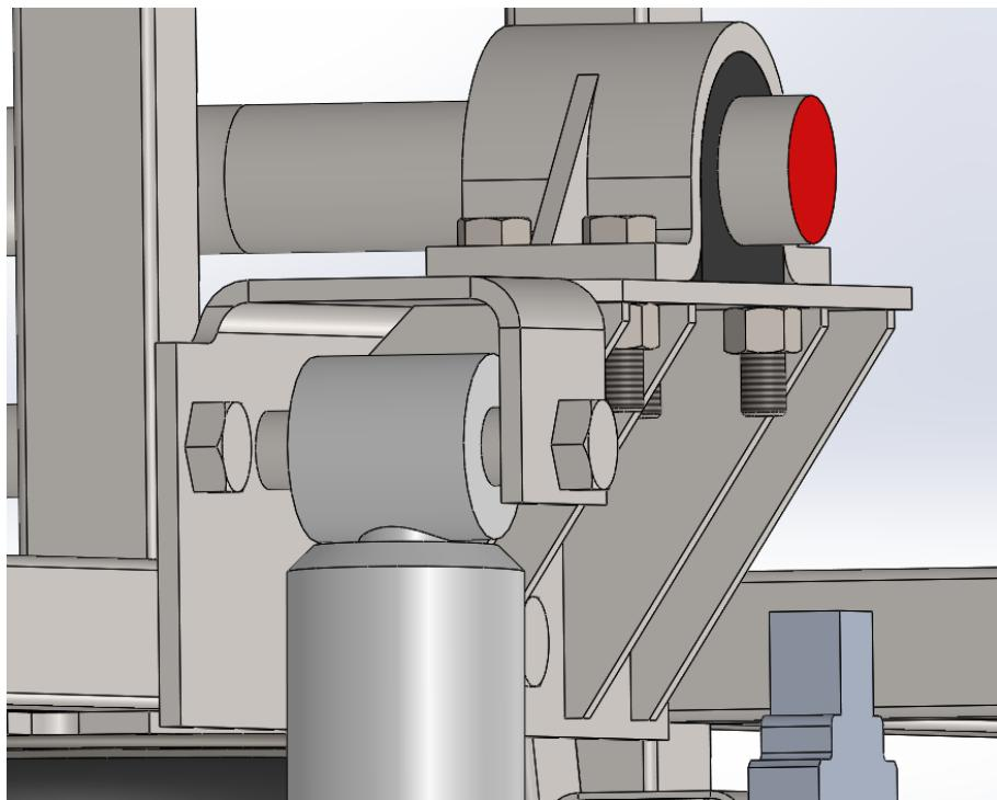
Slika 66. Oslonac gornje glave amortizera i poprečnog stabilizatora
