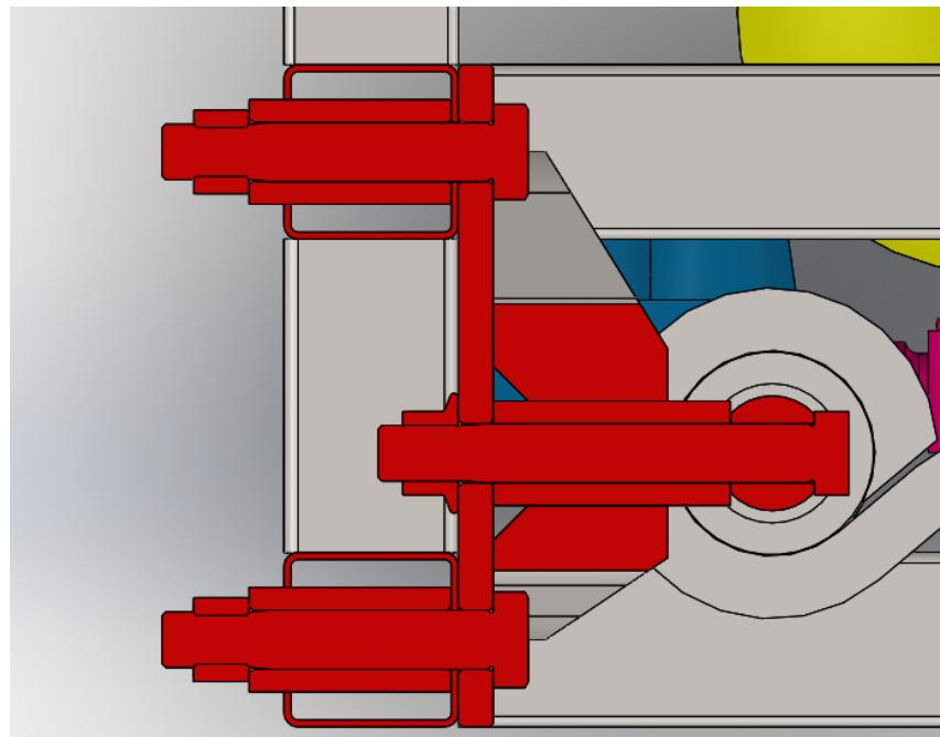
**Slika 55. Prikaz presjeka nosive ploče lisnatih opruga**
