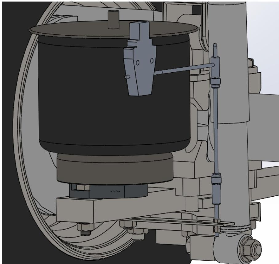
Slika 58. Prikaz zračne opruge postavljene na ovjes
