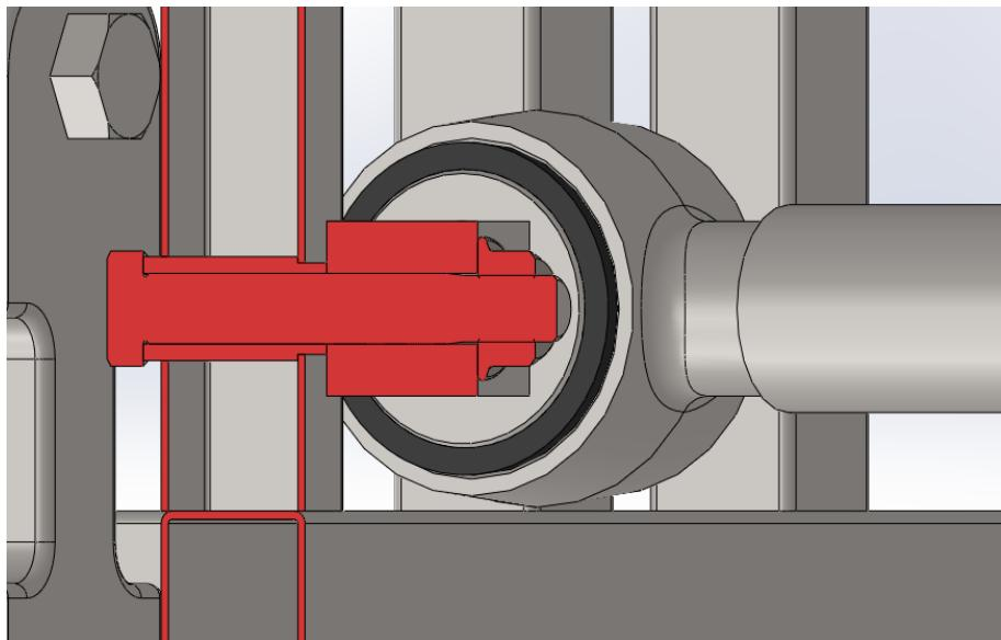
Slika 70. Prikaz spoja vodilice osovine s nosivom konstrukcijom
