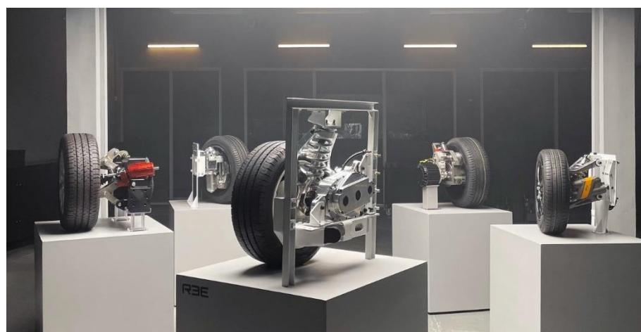
**Slika 16. Pet postojećih konstrukcija REEcorner modula [11]**
