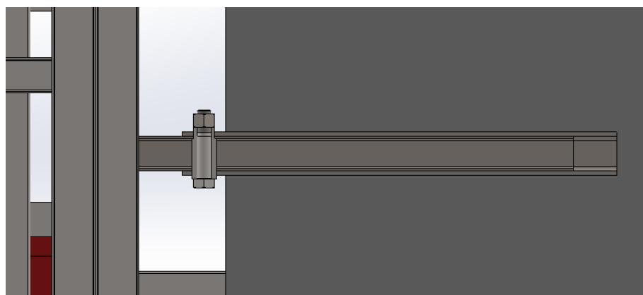
Slika 77. Prikaz spoja dosjednim vijkom i laminirane cijevi unutar kompozita
