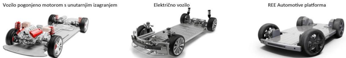
**Slika 19. Usporedba konvencionalog i električnog vozila s REE platformom [9]**
