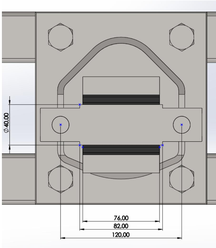
**Slika 82. Presjek i dimenzije svornjaka nosača lisnatih opruga**
