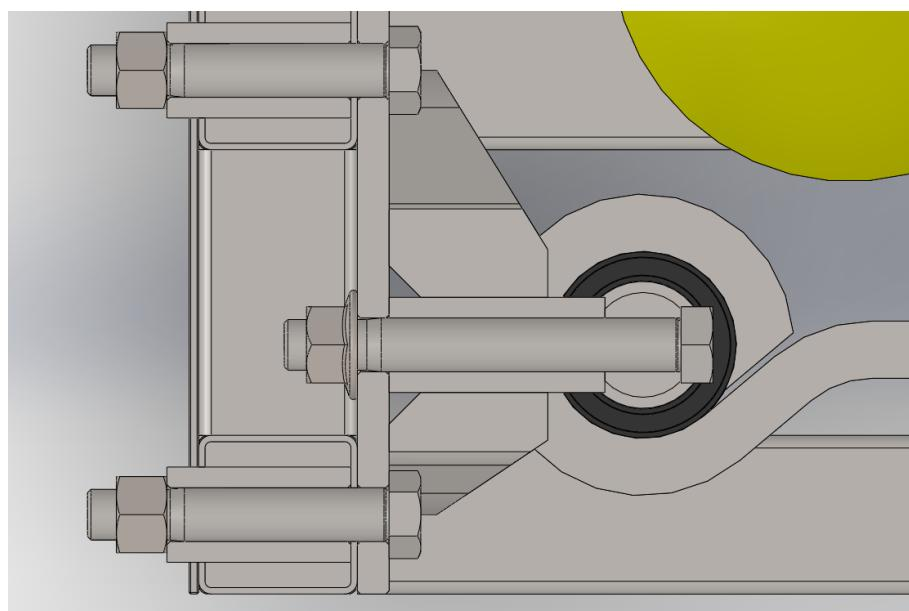
Slika 86. Prikaz spoja nosive ploče lisnatih opruga
