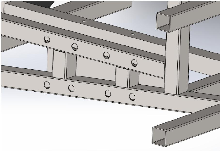
**Slika 49. Vertikalne ukrute na mjestu postavljanja elektromotora**
