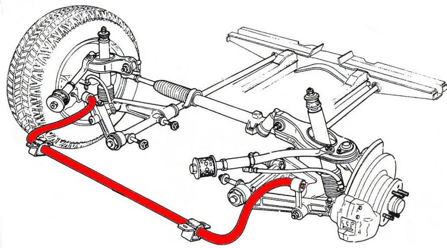
Slika 67. Prikaz poprečnog stabilizatora prednje osovine Alfa Romeo Alfetta [19]
