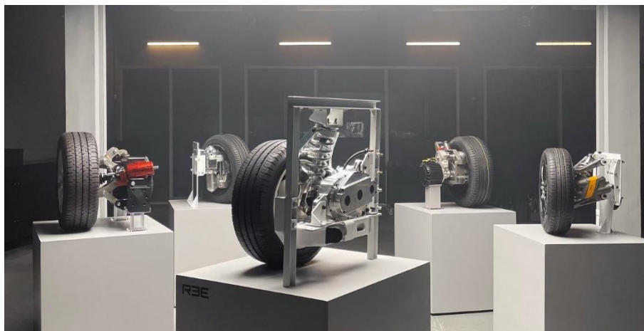
Slika 16. Pet postojećih konstrukcija REEcorner modula [11]
