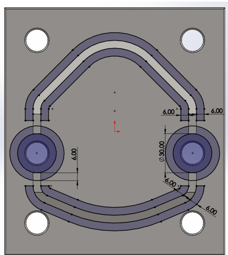
Slika 85. Prikaz zavara na nosivoj ploči
