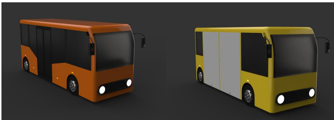
Slika 1. Prikaz primjene različitih središnjih modula [3]
