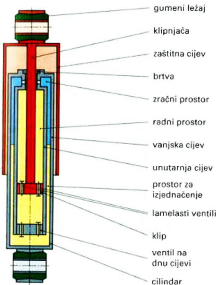
Slika 62. Presjek dvocijevnog hidrauličkog amortizera [18]
