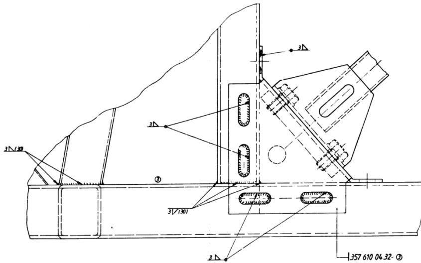
**Slika 48. Prikaz eliptičnih provrta za povećanje površine zavara na konstrukciji autobusa [15]**
