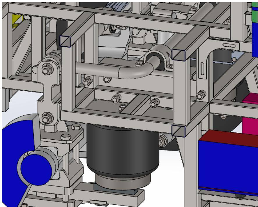
Slika 59. Prikaz oslanjanja zračne opruge i ukrućivanja nosive konstrukcije
