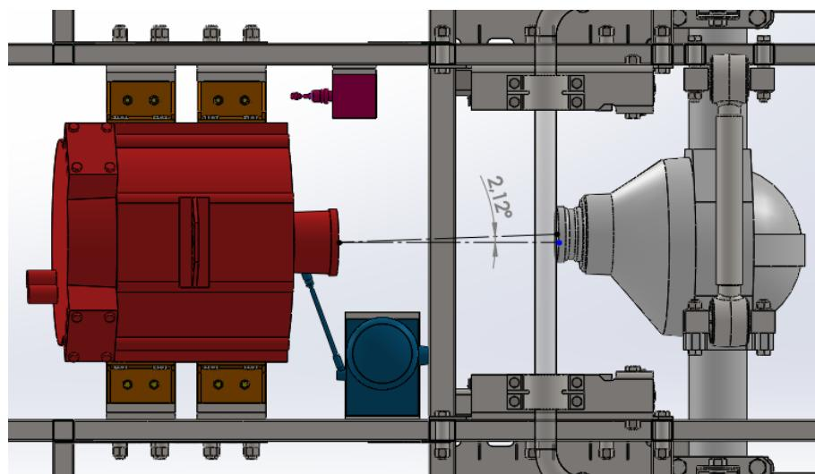
Slika 74. Kutno odstupanje pogonskog motora i diferencijala
