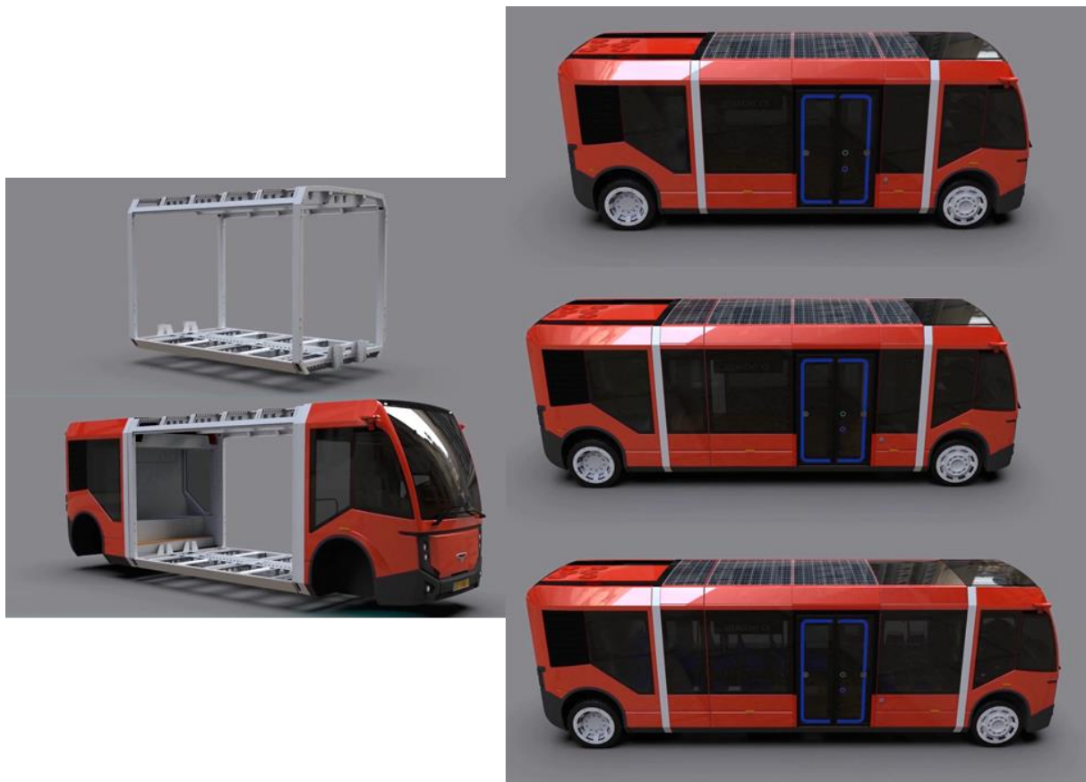
Slika 4. Modularna šasija i prikaz mogućih konfiguracija duljine [5]
