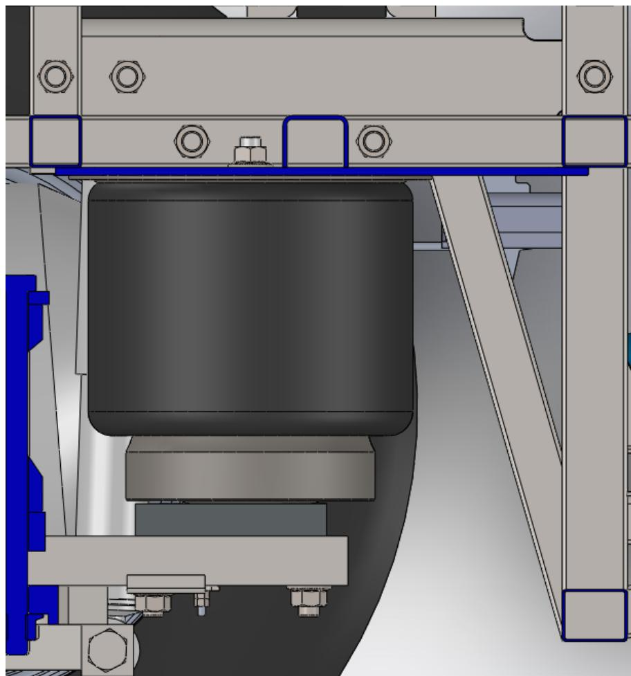
Slika 61. Prikaz nosive ploče zračne opruge i načina ukrućivanja ploče
