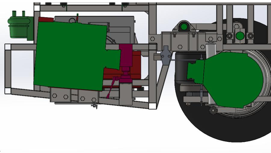
Slika 73. Smještaj pogonskog motora i diferencijala pod kutom od  $4,5^\circ$
