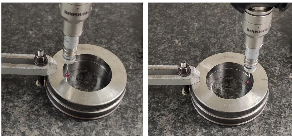
Slika 21. Dovođenje ticala u dodir sa unutarnjom stranom prstena u oba smjera  $x$ -osi
