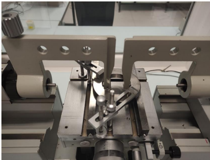
Slika 10. Postavljanje i učvršćivanje referentnog prstena
