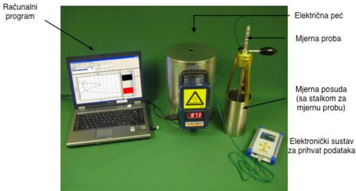
Slika 12. IVF Smart Quench mjerni sustav [14]
