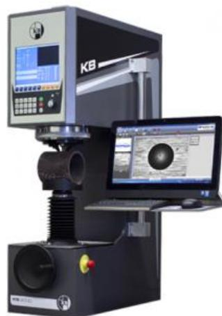
Slika 6. Uredaj (tvrdomjer) za ispitivanje tvrdoće po Brinell-u. Model KB 250 - 3000 [5]
