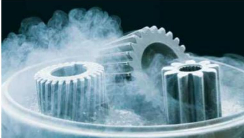
Slika 11. Duboko hlađenje u ukapljenom dušiku (do -196\text{ }^{\circ}\text{C} ) [9]
