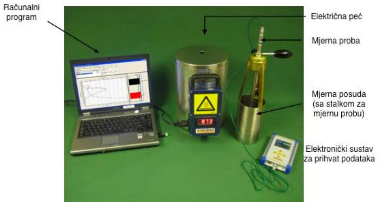
Slika 12. IVF Smart Quench mjerni sustav [14]
