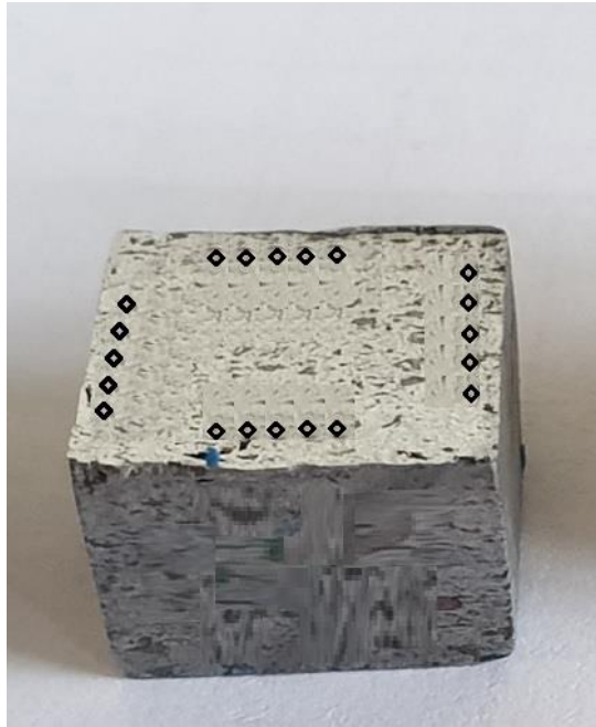
Slika 30. Mjesta ispitivanja tvrdoće uz rubove
