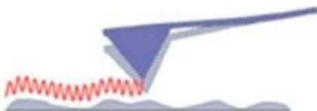
Slika 16. Shematski prikaz rada beskontaktna metode AFM-a [32]
