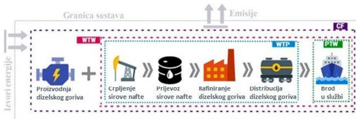
Slika 25. LCA dizelskog pogonskog sustava [14].
