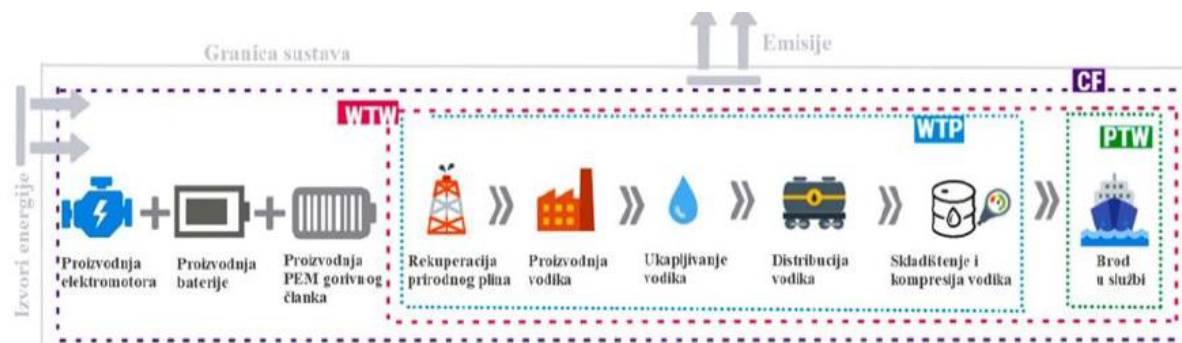
Slika 44. LCA pogonskog sustava na vodik [3].
