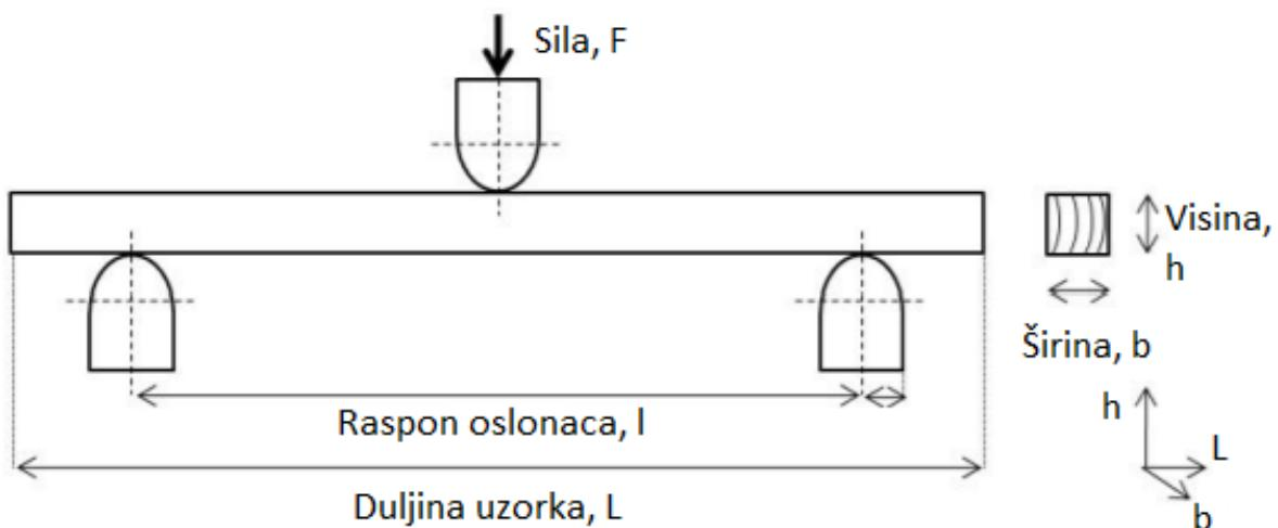
Slika 6. Shema ispitivanja savijanjem u tri točke [8]
