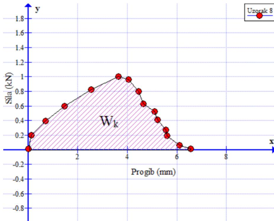
Slika 71. Konvertirani dijagram sile – progib u programskom paketu *Graph*, uzorak 8
