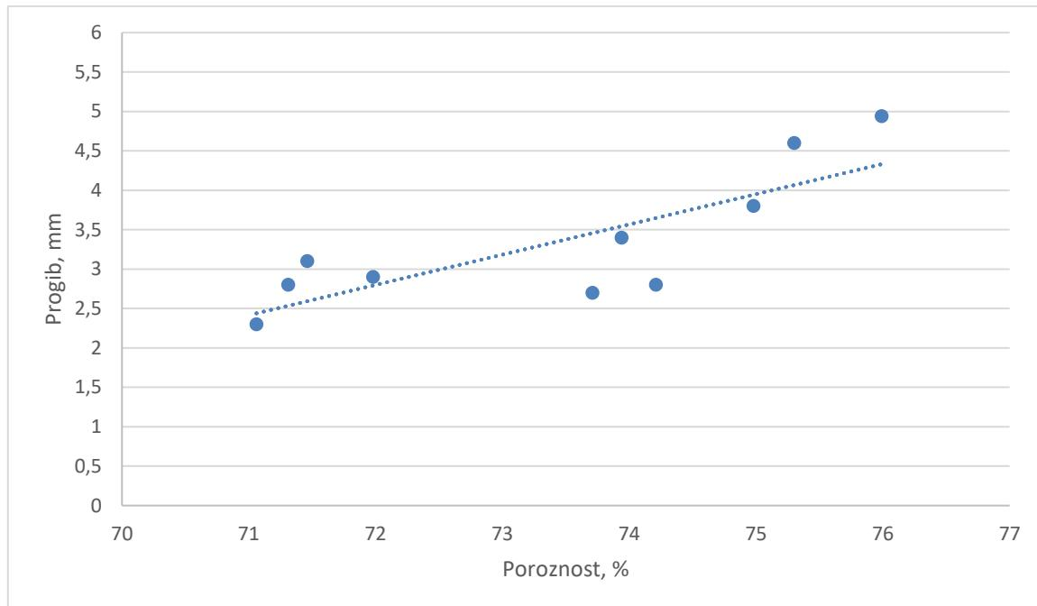
Slika 55. Ovisnost progiba o poroznosti aluminijeve pjene
