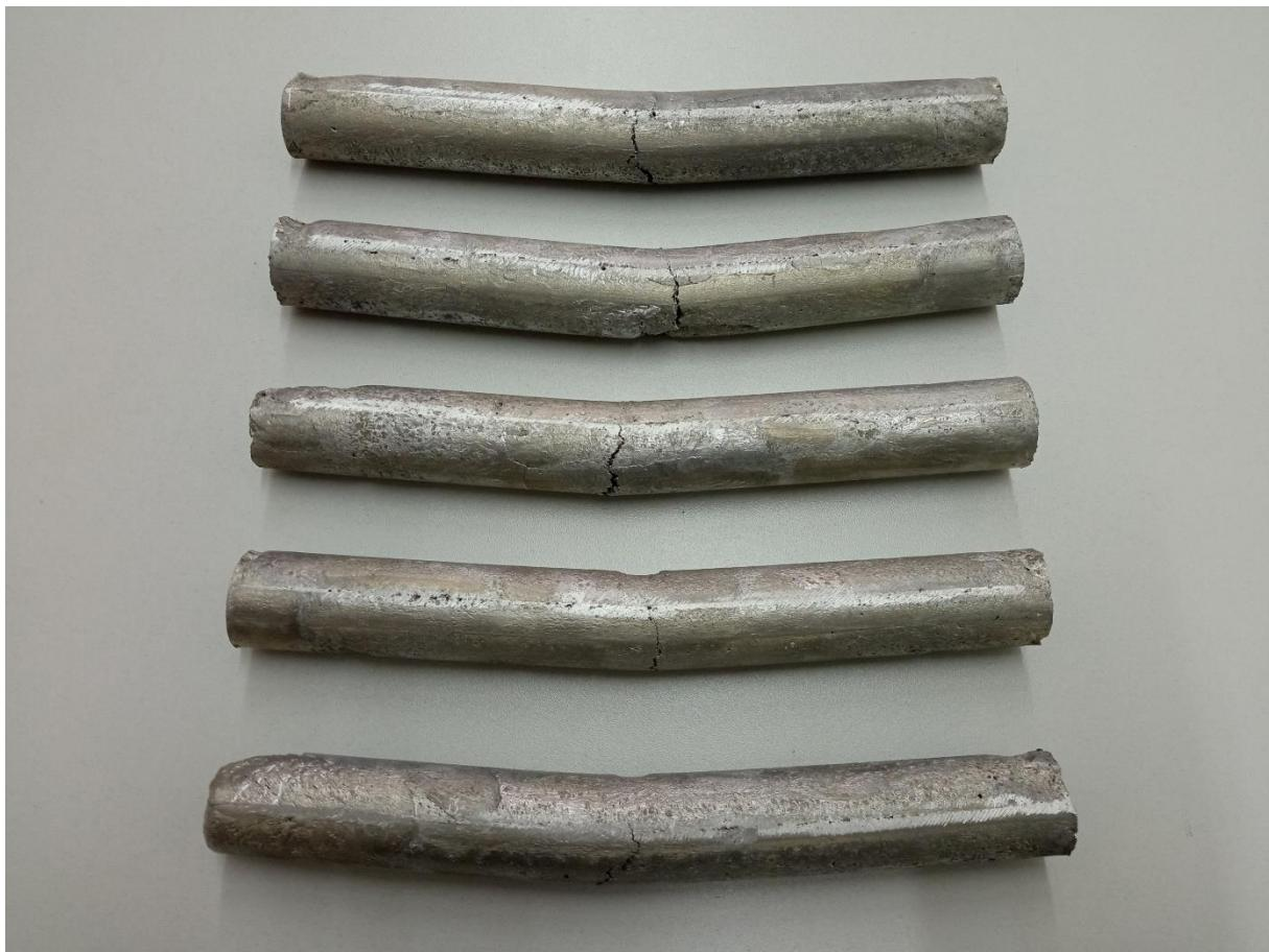
**Slika 45.** Uzorci nakon ispitivanja savijanjem u tri točke
