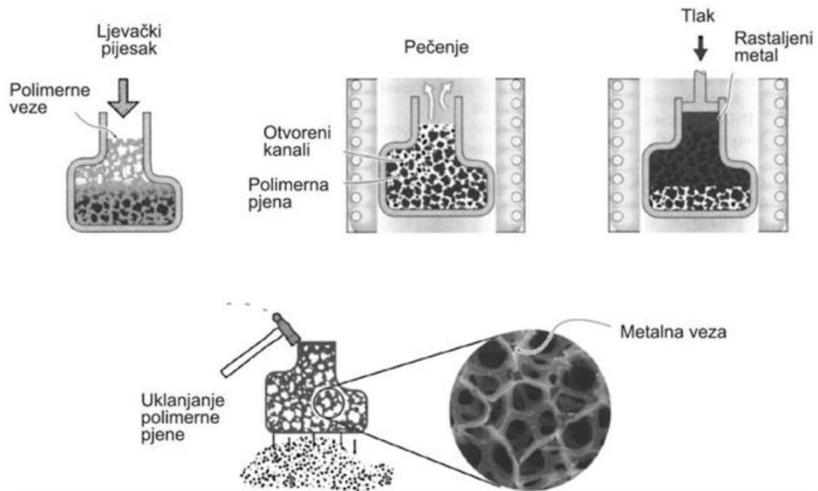
Slika 19. Shema preciznog lijevanja metalnih pjena [7]
