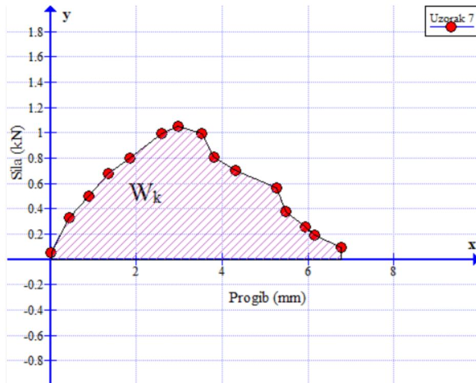
Slika 69. Konvertirani dijagram sile – progib u programskom paketu Graph, uzorak 7
