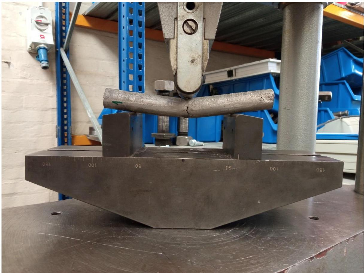
Slika 42. Naprava za ispitivanje savijanjem u tri točke
