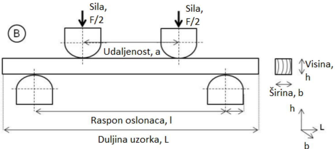
**Slika 7. Shema ispitivanja savijanjem u četiri točke [8]**
