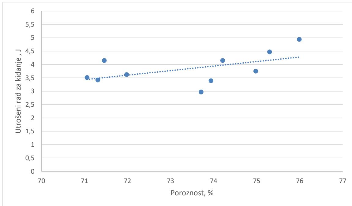
Slika 54. Ovisnost utrošenog rada za kidanje o poroznosti aluminijeve pjene
