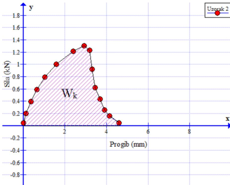
Slika 59. Konvertirani dijagram sile – progib u programskom paketu Graph, uzorak 2
