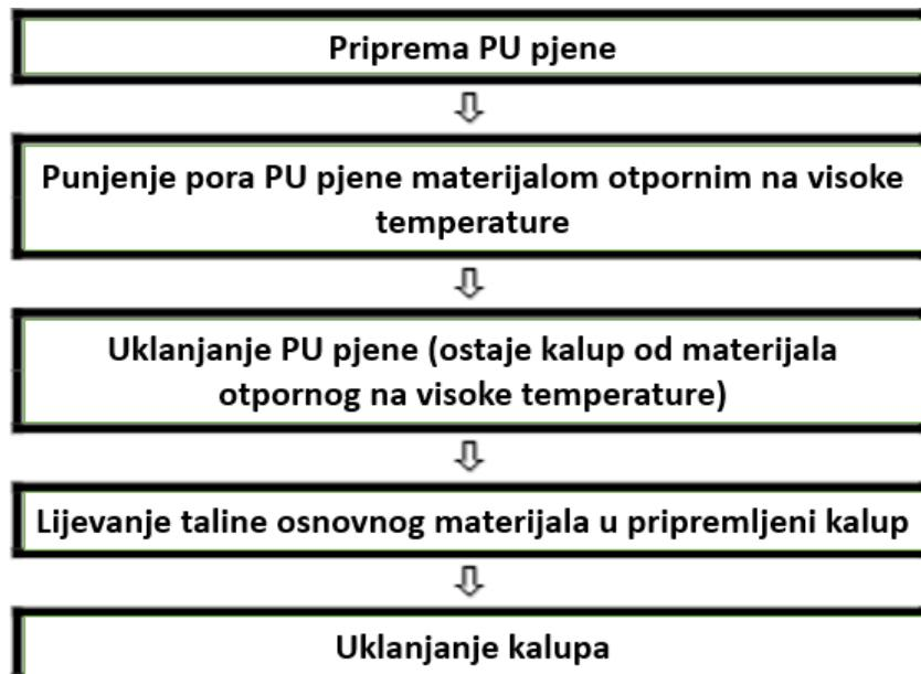
Slika 20. Faze preciznog lijevanja metalnih pjena [6]
