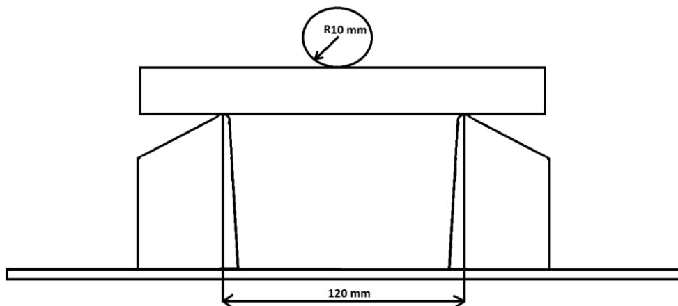
Slika 43. Shema savijanja u tri točke s dimenzijama
