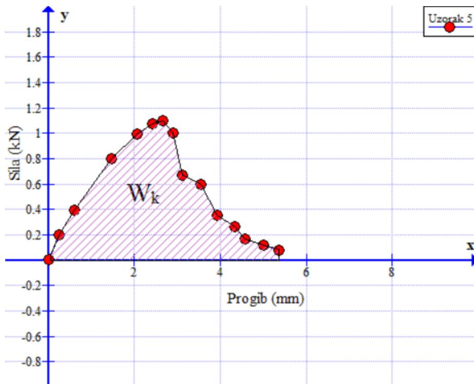
Slika 65. Konvertirani dijagram sile – progib u programskom paketu *Graph*, uzorak 5
