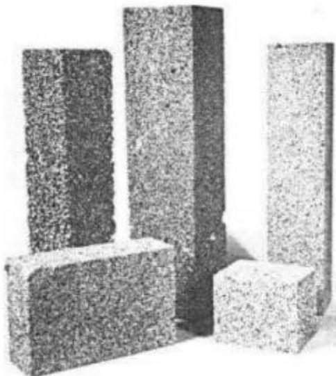
**Slika 1. Blokovi od aluminijeve pjene proizvedeni u Ethyl korporaciji [2]**
