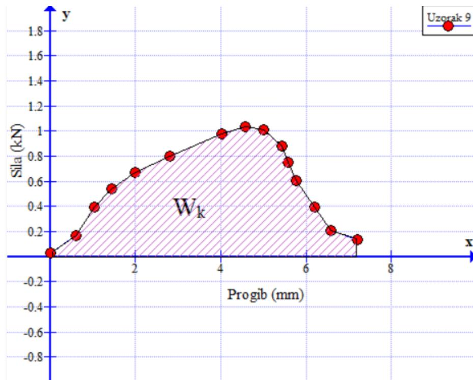
Slika 73. Konvertirani dijagram sila – progib u programskom paketu Graph, uzorak 9
