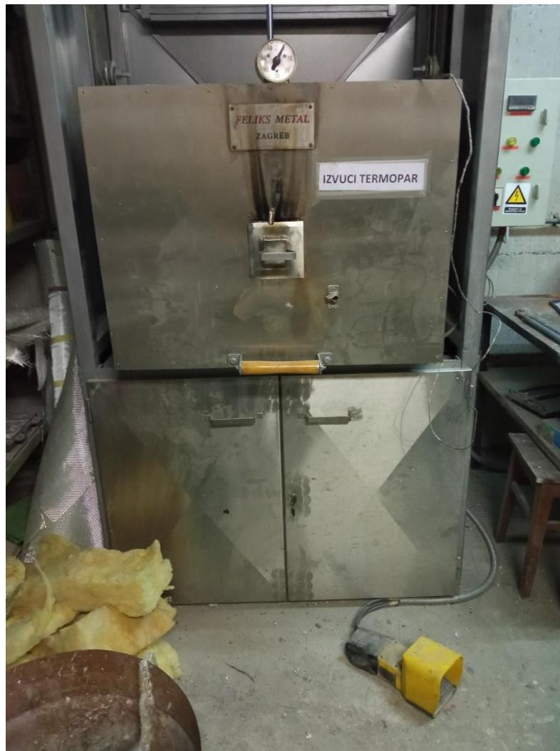
Slika 38. Elektrootporna zvonasta peć
