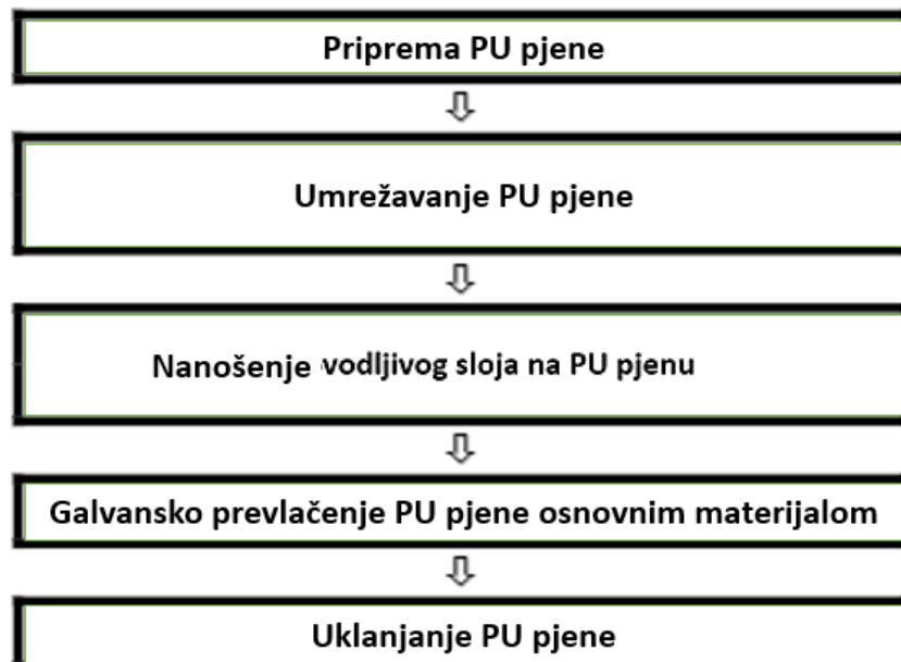
Slika 26. Faze postupka proizvodnje metalnih pjena prevlačenjem [6]
