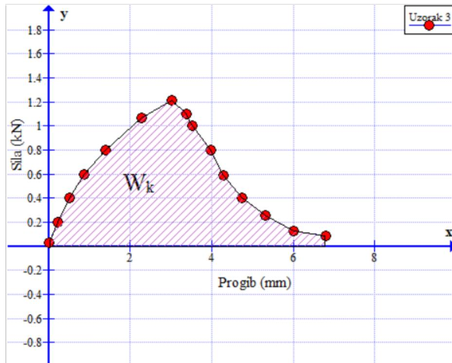
Slika 61. Konvertirani dijagram sile – progib u programskom paketu Graph, uzorak 3
