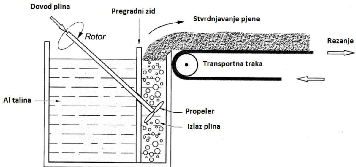
Slika 13. Shematski prikaz procesa direktnog upjenjivanja [14]
