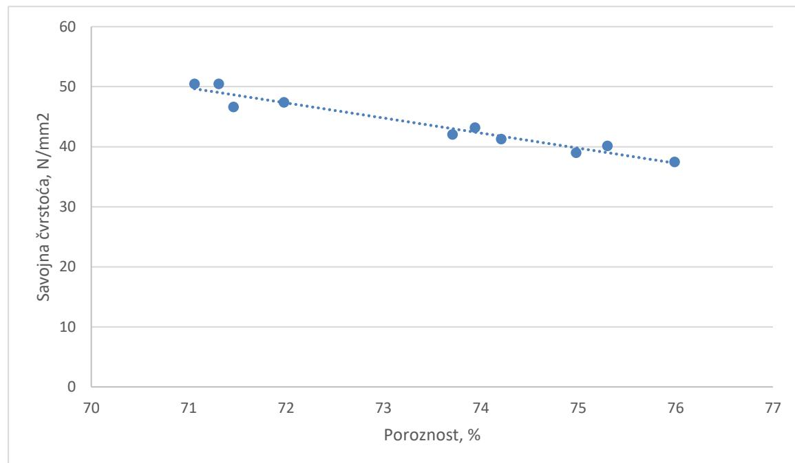
**Slika 53. Ovisnost savojne čvrstoće o poroznosti aluminijeve pjene**
