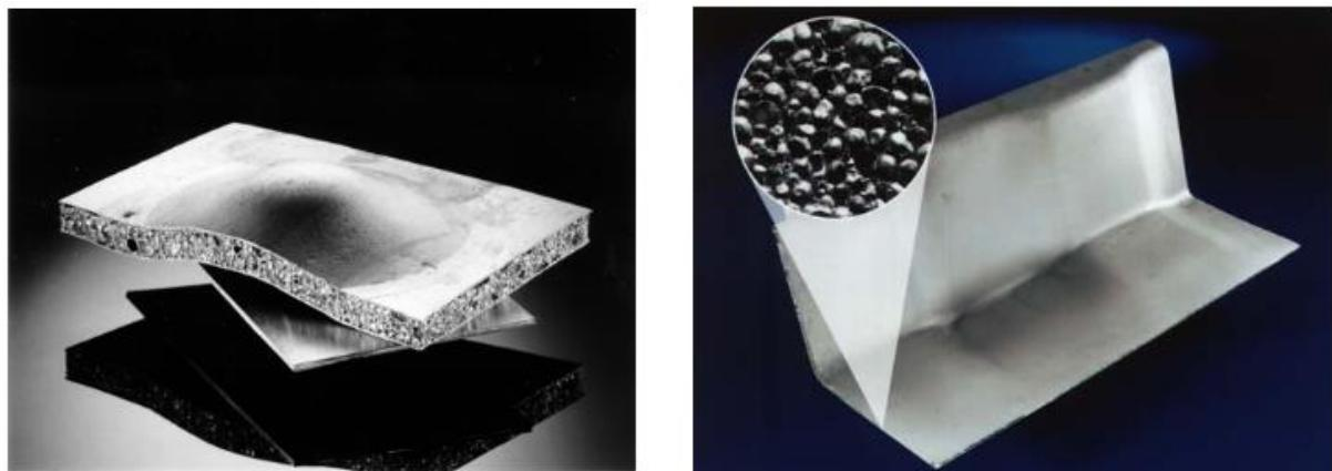
Slika 23. Sendvič konstrukcije proizvedene Fraunhofer procesom [6]
