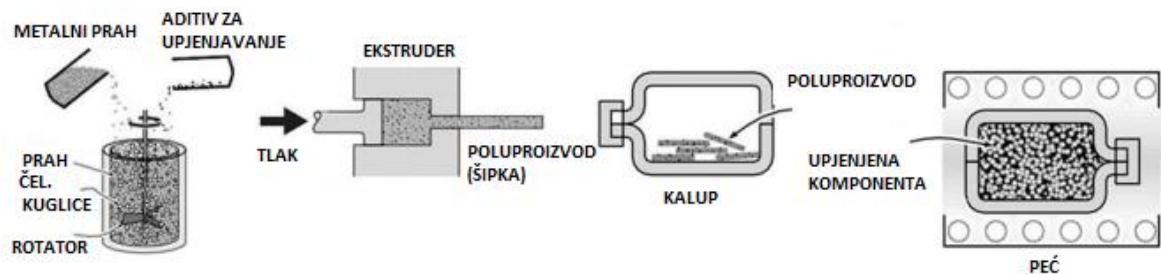
Slika 22. Shema Fraunhofer procesa proizvodnje metalnih pjena [16]
