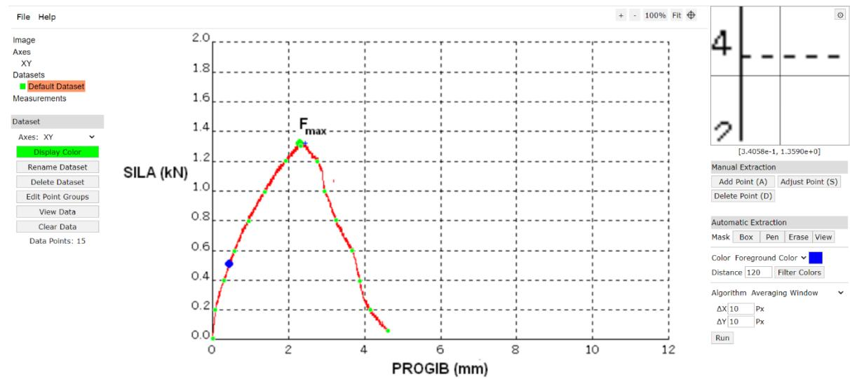
Slika 46. Određivanje točaka uz pomoć „WebPlotDigitizer“ alata
