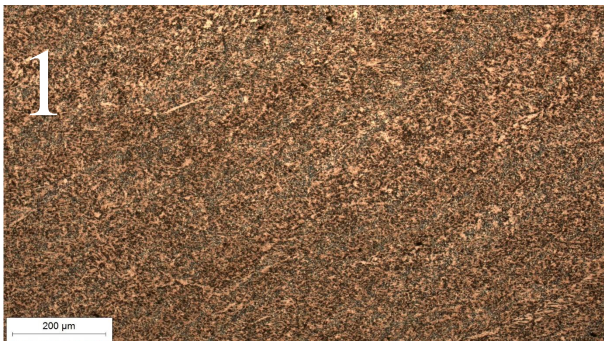
Slika 51. Mikrostruktura metala zavara, Uzorak 1
