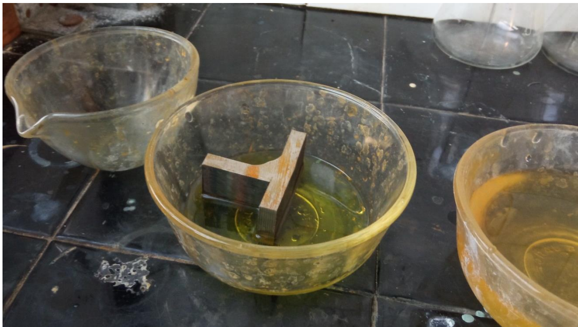
Slika 53. Nagrizzanje uzoraka u otopini nitala
