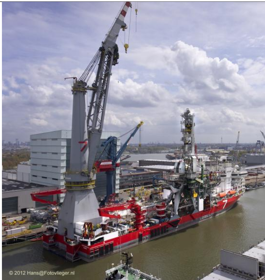
Slika 4. Dizalica od čelika S690QL [9]
