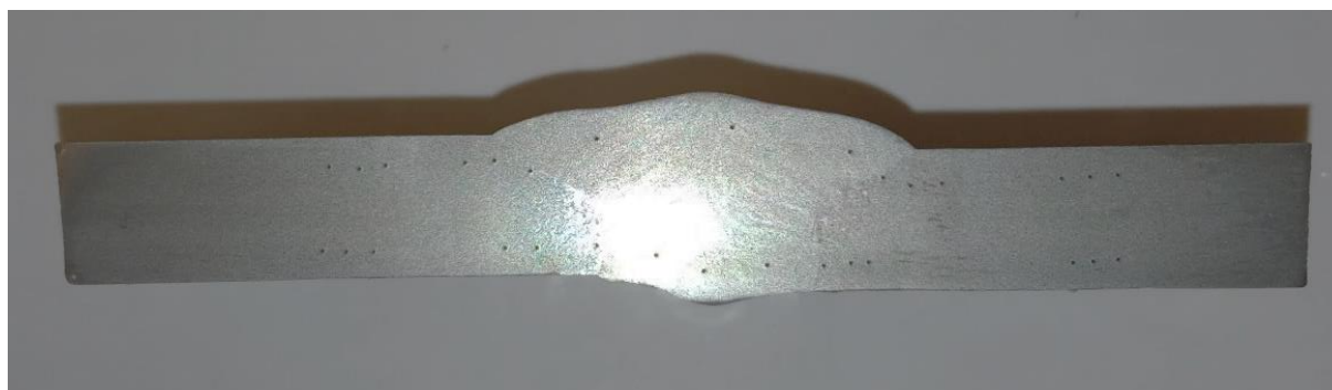
Slika 64. Položaji otisaka, uzorak 2
