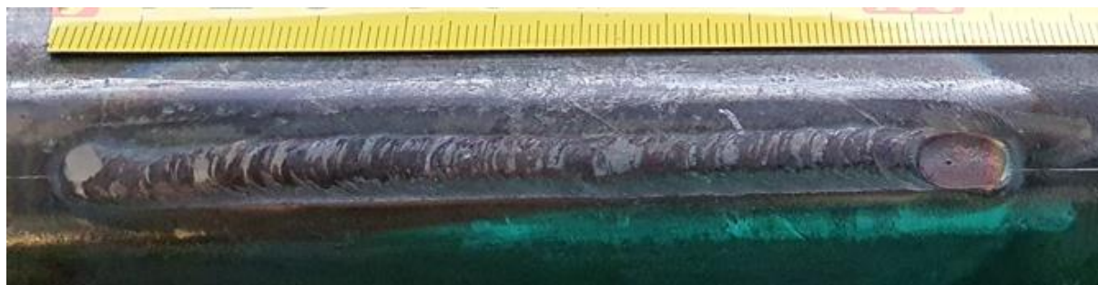
Slika 60. Referentni uzorak R1 pretaljivan istosmjernom strujom
