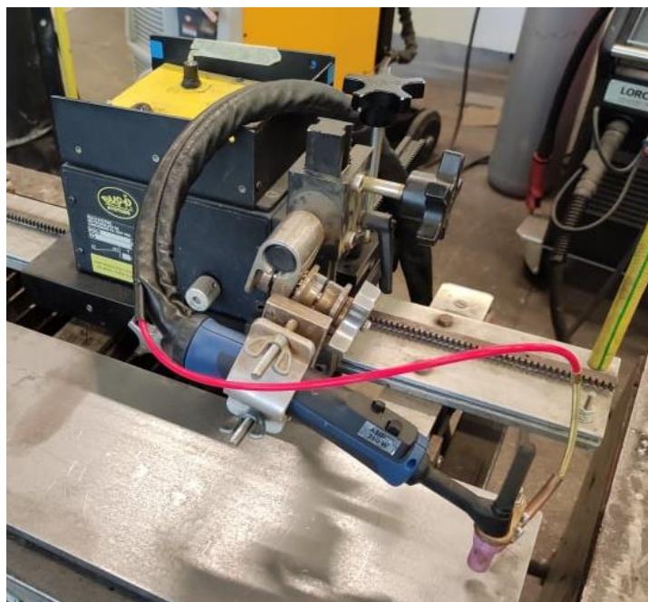
Slika 58. Bug-O sustav za automatizirani postupak zavarivanja
