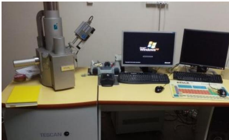
Slika 22. Pretražni elektronski mikroskop (SEM) Tescan Vega TS5136MM (Tescan Orsay Holding, a.s., Češka)
