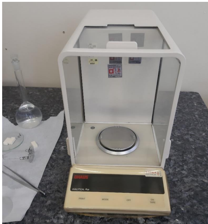
Slika 24. Analitička vaga Ohaus AP250D (Ohaus Europe GmbH, Švicarska)
