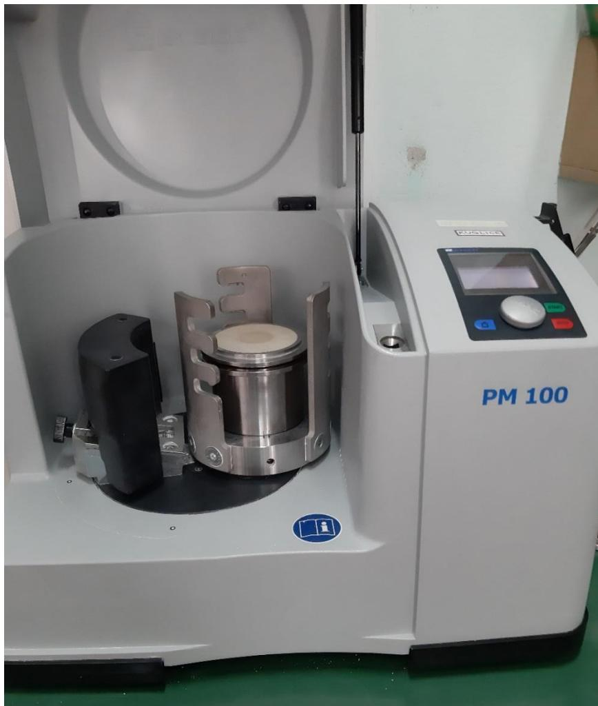
**Slika 15. Planetarni kuglični mlin (PM 100, Retsch GmbH, Njemačka)**
