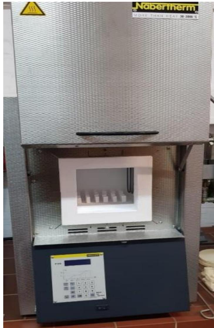
**Slika 20.** Laboratorijska peć za sinteriranje Nabertherm P310 (Nabertherm GmbH, Njemačka)
