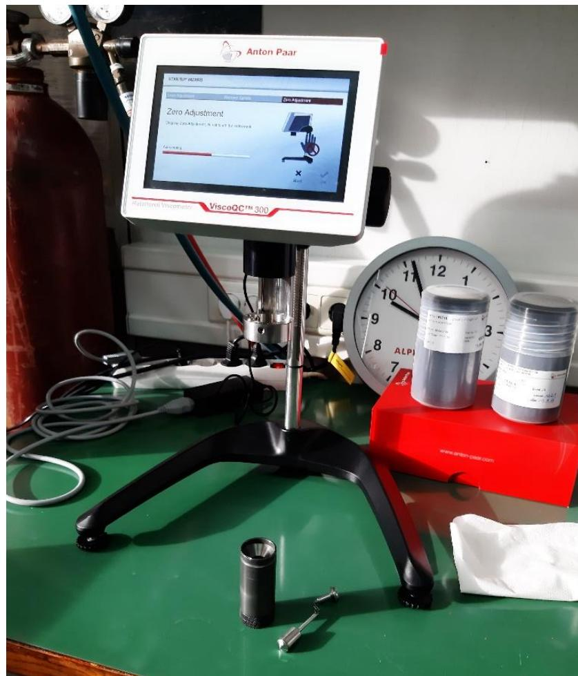
**Slika 17. Rotacijski viskozimetar – Anton Paar ViscoQC 300**
