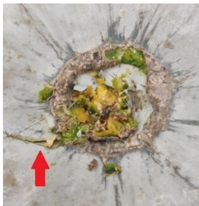
Slika 32. Oštećenje na bundevi nakon ispuštanja utega mase 1 kg s visine 1 m
