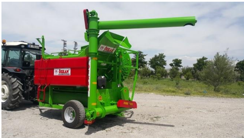
Slika 13. Kombajn za bundeve Özkan Tarim Makina s ježom i transporterom [10]
