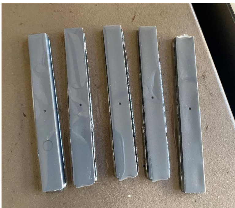
Slika 5.15. Ispitna tijela PS nakon provedenog ispitivanja metodom A50
