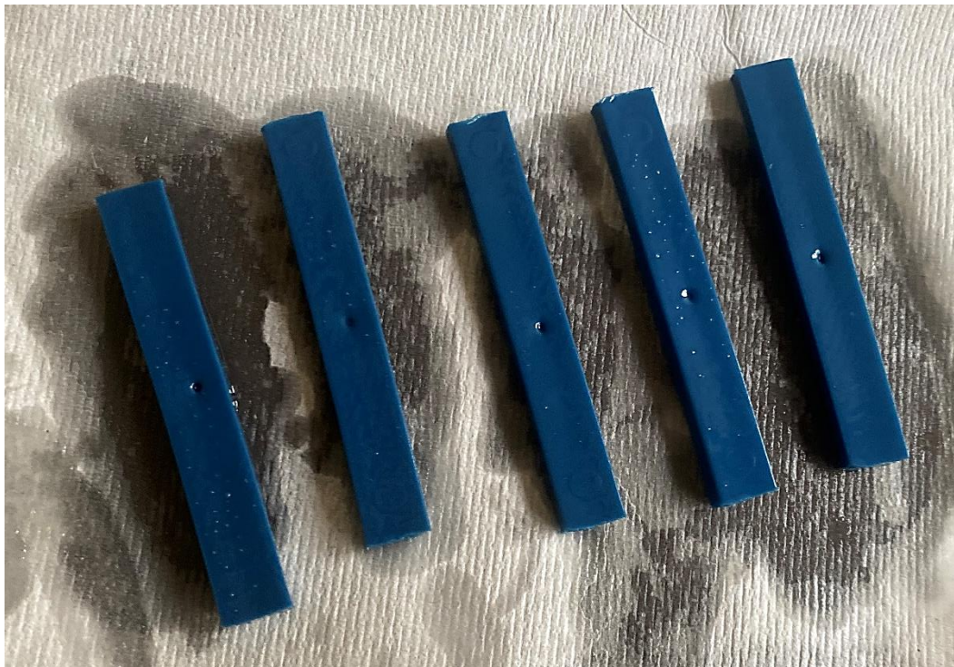
Slika 5.17. Ispitna tijela PE - HD nakon provedenog ispitivanja metodom A50
