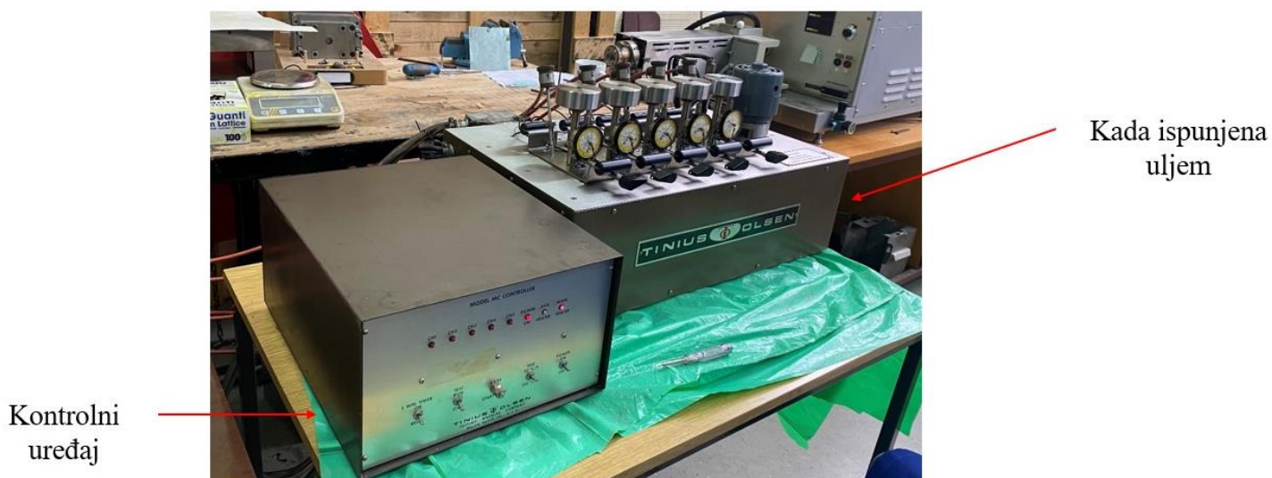
Slika 5.1. Kada ispunjena uljem i kontrolni uređaj
