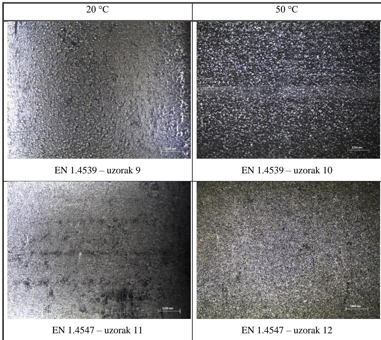
**Tablica 20. Stereomikroskopske snimke uzoraka osnovnog metala austenitnih čelika nakon koroziju ispitivanja**
