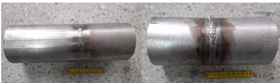
Slika 17. Prikaz zavarenog spoja na cijevi od čelika EN 1.4539 (AISI 904L) - lijevo i EN 1.4547 (254 SMO) - desno
