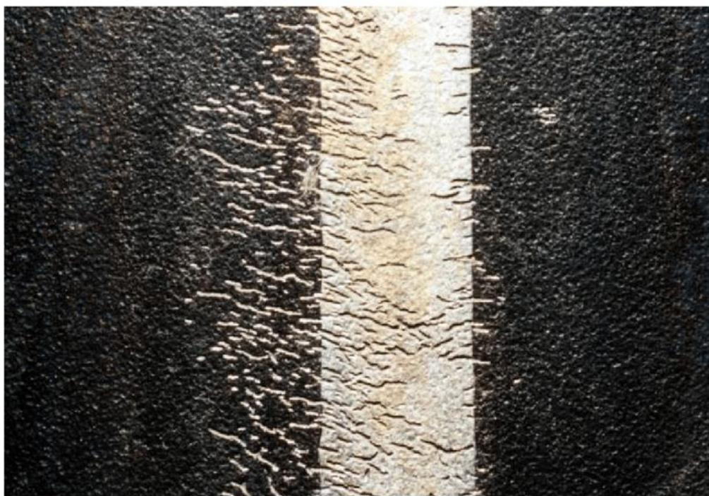
Slika 13. Pojava pukotina zbog napetosne korozije na zavaru cijevi od nehrđajućeg čelika [27]
