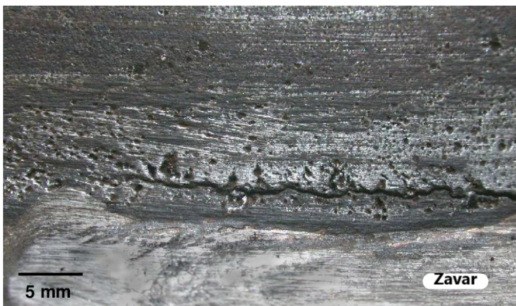
Slika 12. Pojava rupičaste korozije u ZUT-u oko zavara od nehrđajućeg čelika [26]
