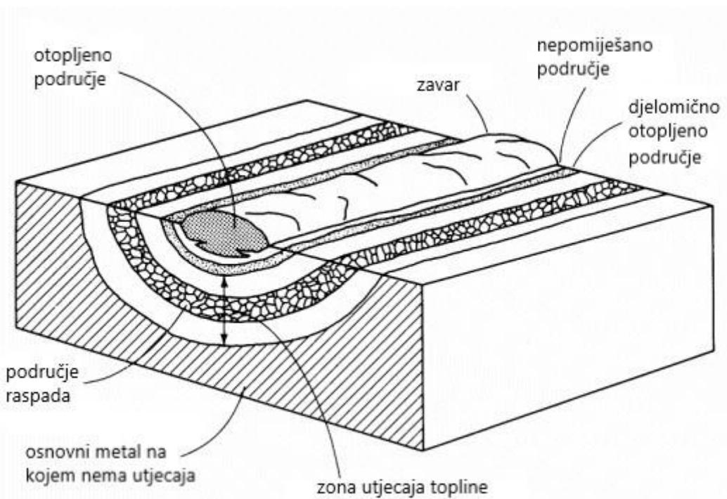
**Slika 9. Interkristalna korozija (raspad zavara) na zavarenom spaju od nehrđajućeg čelika [24]**
