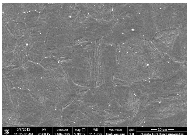
Slika 7. Mikrostruktura precipitacijski očvrsnutog nehrđajućeg čelika [12]
