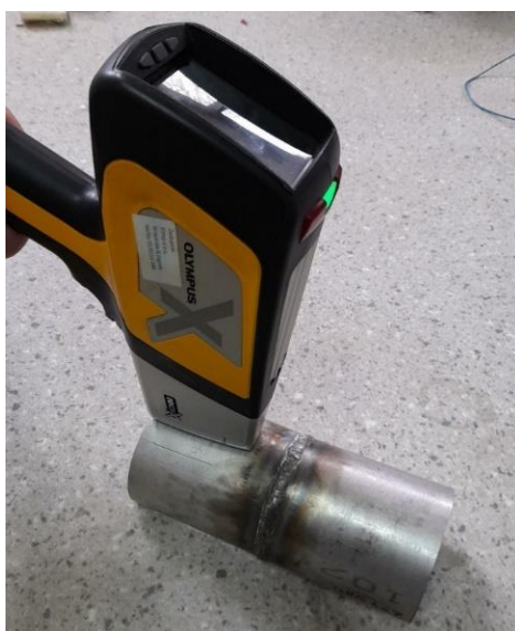
Slika 19. XRF ispitivanje kemijskog sastava
