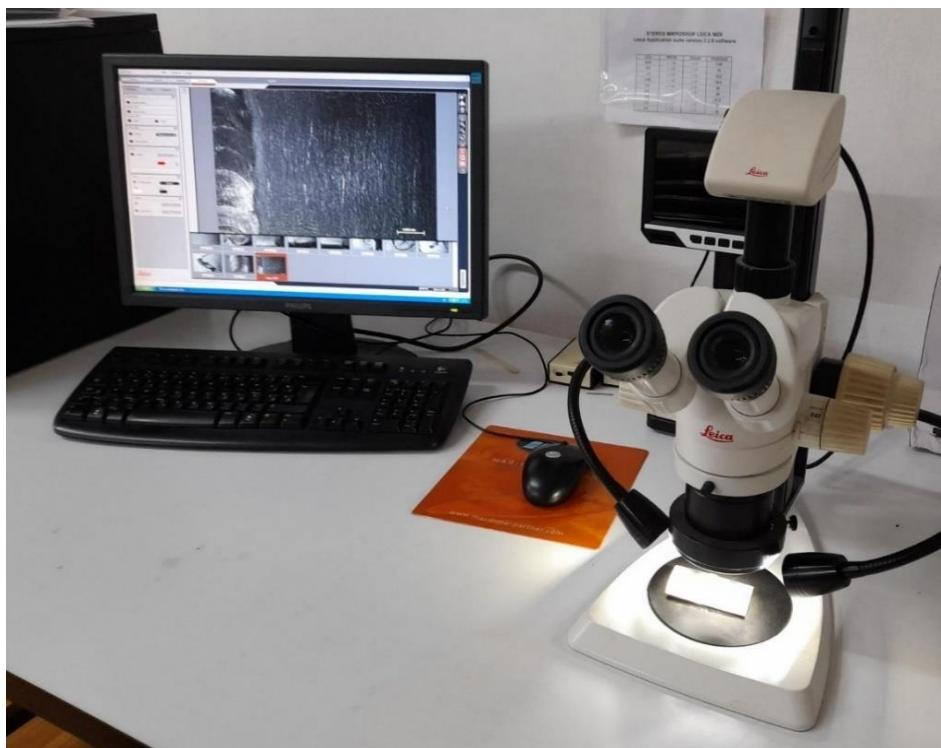
**Slika 20.** Oprema za stereomikroskopsko ispitivanje – stereomikroskop Leica MZ6
