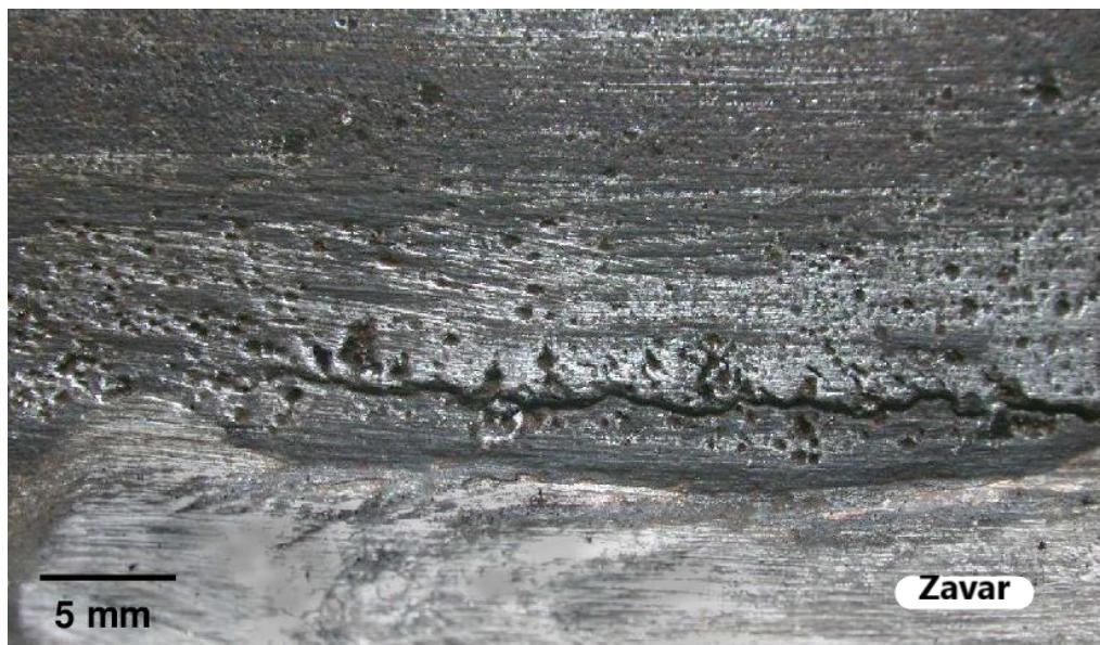
Slika 12. Pojava rupičaste korozije u ZUT-u oko zavara od nehrđajućeg čelika [26]
