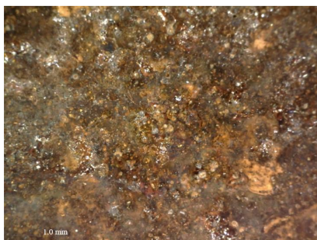
Slika 43. Površina uzorka tretiranog kiselom kišom nakon 6 mjeseca
