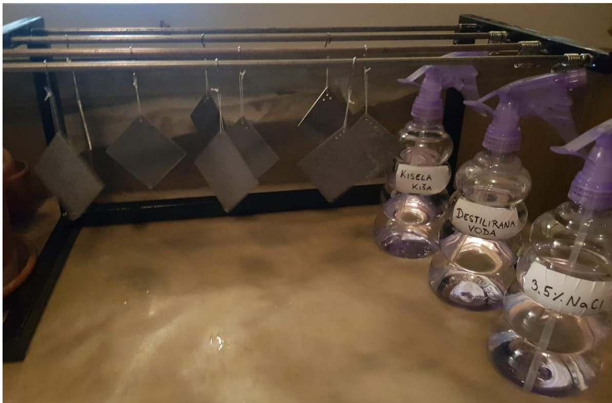
Slika 19. Ispitni uzorci na metalnom stalaku
