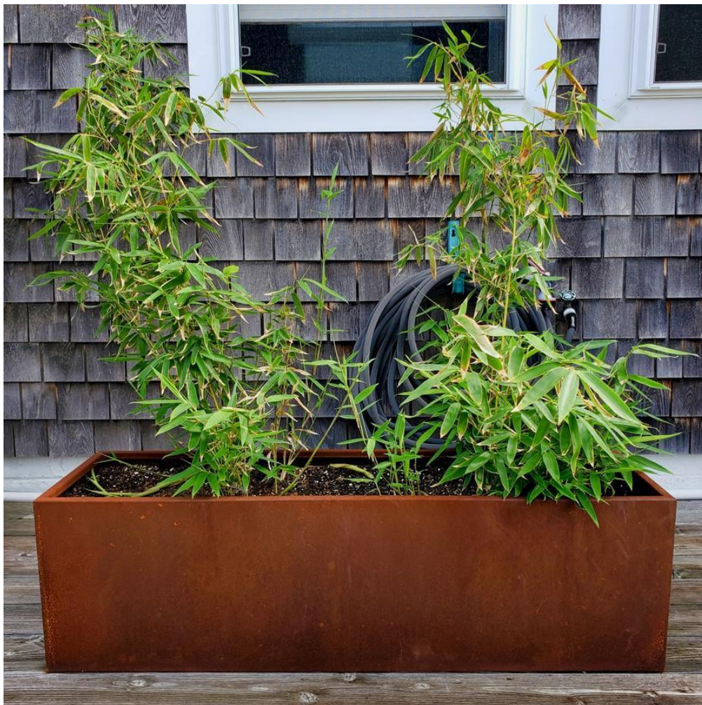
Slika 3. Posuda za cvijeće od Corten čelika nakon duljeg izlaganja atmosferskim uvjetima [16]
