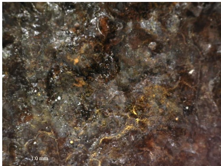
Slika 37. Površina uzorka tretiranog morskom vodom nakon 6 mjeseca
