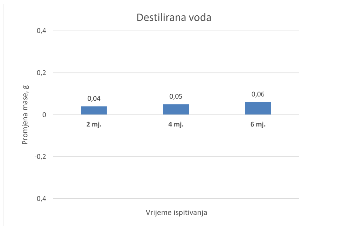
Slika 31. Promjene mase kod uzoraka tretiranih destiliranom vodom
