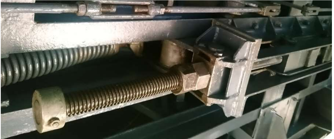
Slika 20 Vreteno za ravnotežu klackalice - slika sa servisa 25.10.2021.
