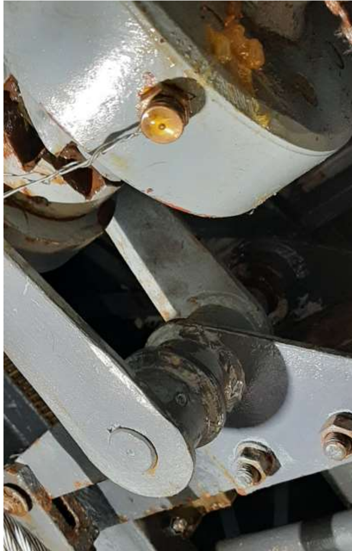
Slika 45 Aktiviranje kandžaste spojke - slika sa servisa 25.10.2021.
