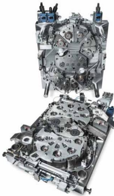
Slika 5. Alat za oblikovanje deformiranjem izrađen od čelika K490 MC
