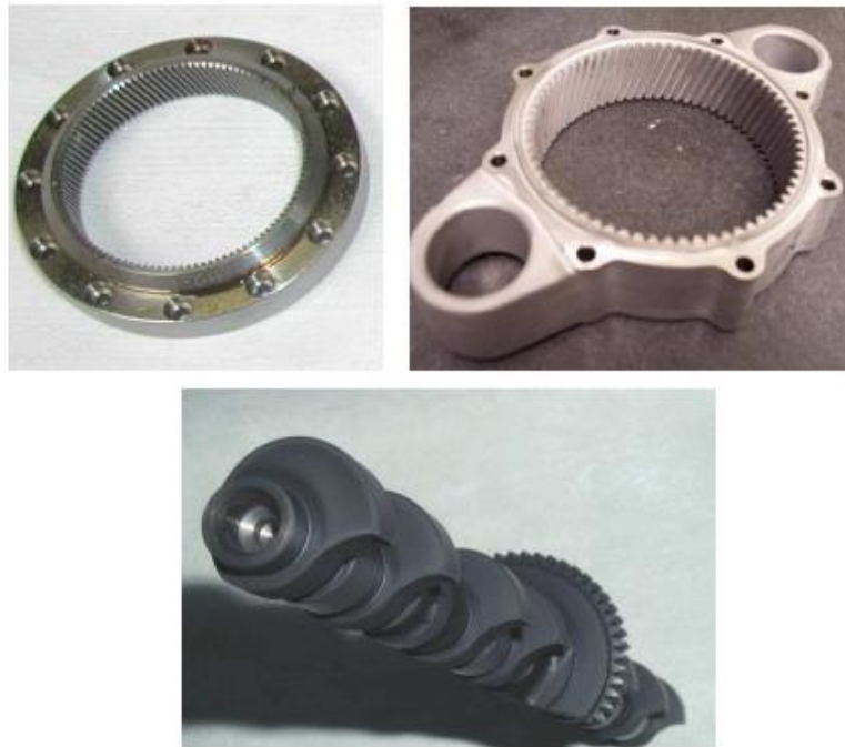
Slika 11. Primjeri dijelova pogodnih za nitriranje u plazmi [11]
