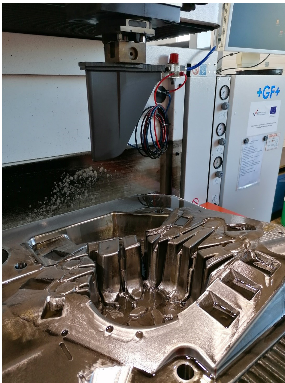
Slika 24 Primjer EDM obrade utora kod izrade kalupa
