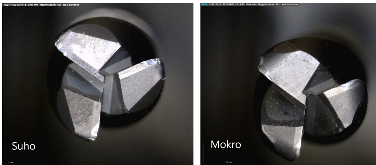
Slika 69 Prikaz trošenja stražnje površine glodala s radijusom pod mikroskopom
