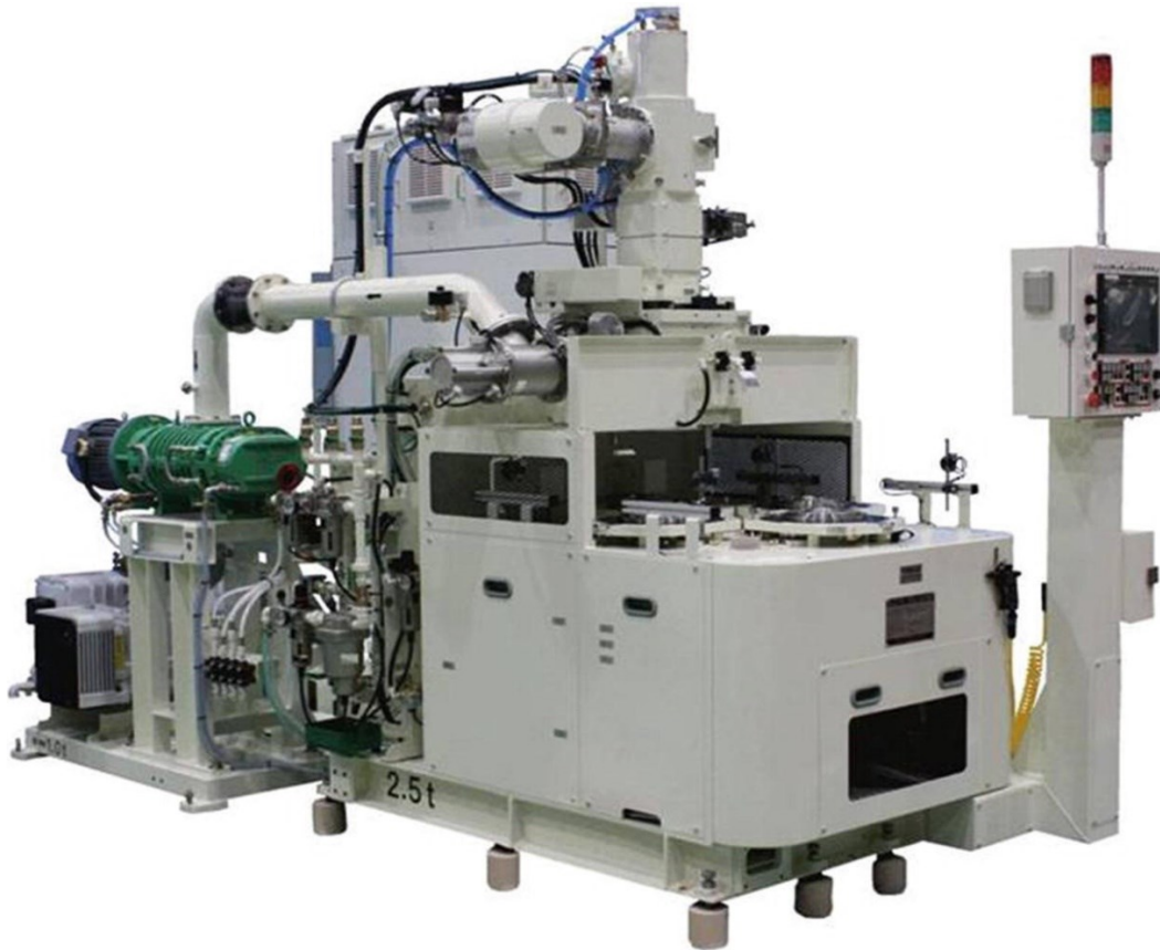
Slika 41 Stroj za obradu snopom elektrona [29]
