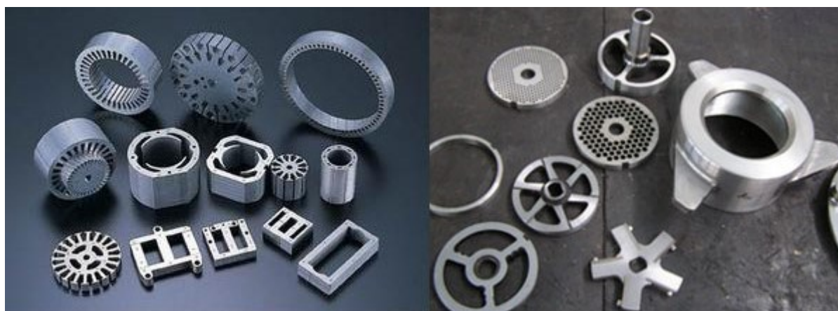
Slika 32 Primjeri proizvoda izrađenih pomoći WEDM [20]
