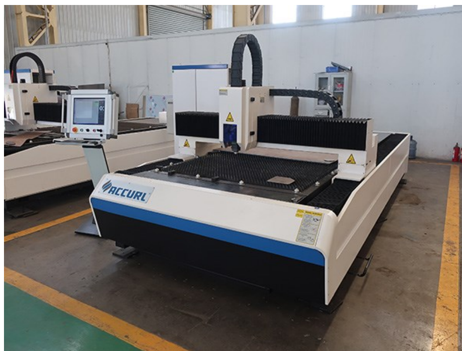
Slika 35 CNC stroj za rezanje laserom [25]
