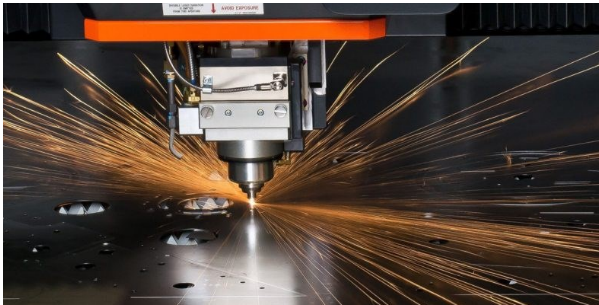
Slika 34 Lasersko rezanje metala [22]
