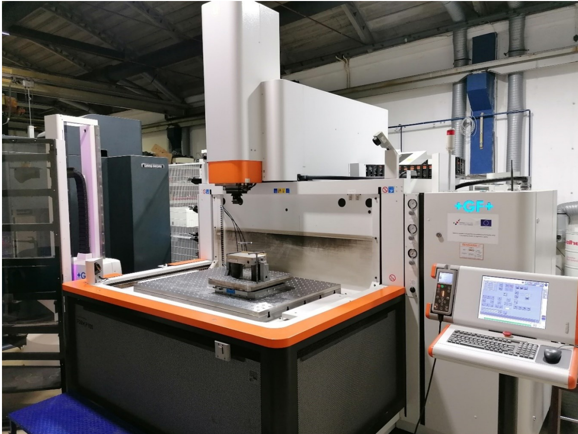
Slika 13 Primjer stroja za obradu elektroerozijom
