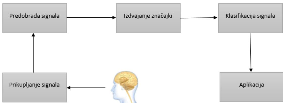
**Slika 16. Shematski prikaz obrade signala**
