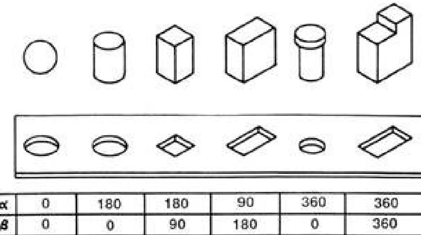
Slika 65. Različiti objekti s pripadnim kutovima rotacijske simetrije  $\alpha$  i  $\beta$  [ $^\circ$ ] [39]
