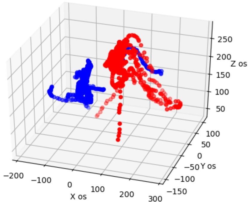
**Slika 62. Trajektorije ruku prilikom pritezanja dva dijelova vijkom**
