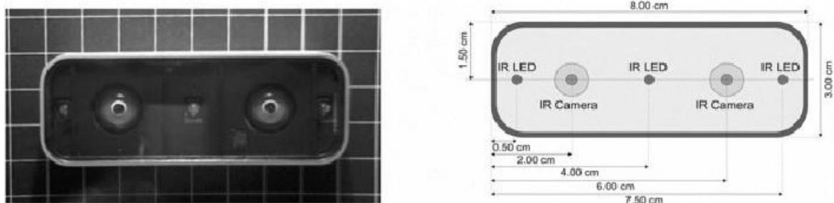
**Slika 26. Konstrukcija uređaja *Leap Motion Controller* [33]**
