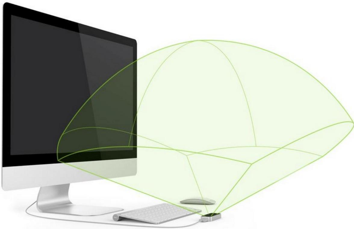
**Slika 27. Vidno polje uređaja *Leap Motion Controller* [34]**
