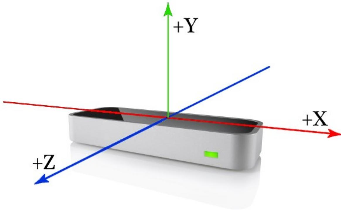
**Slika 28. Koordinatni sustav uređaja *Leap Motion Controller* [36]**
