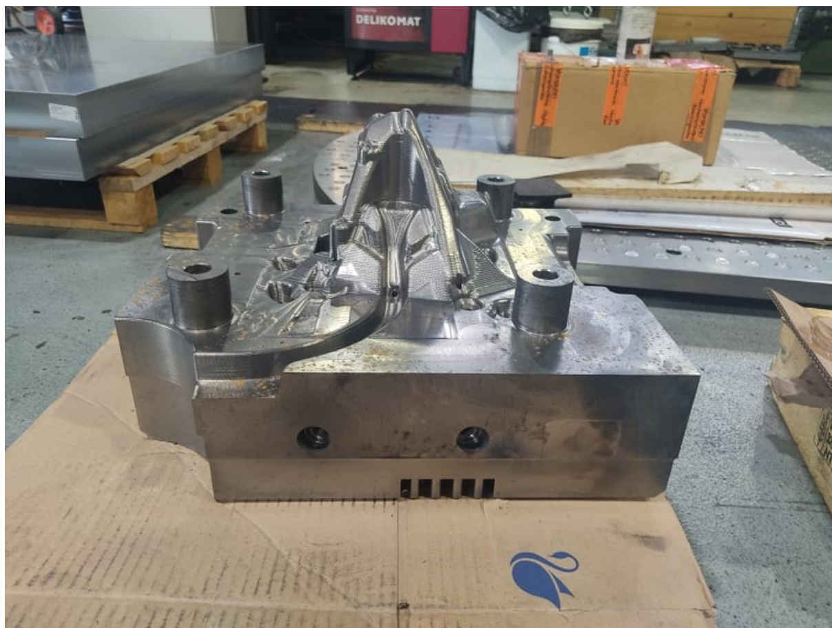
Slika 38. Obradak kalupnog uloška nakon termičke obrade
