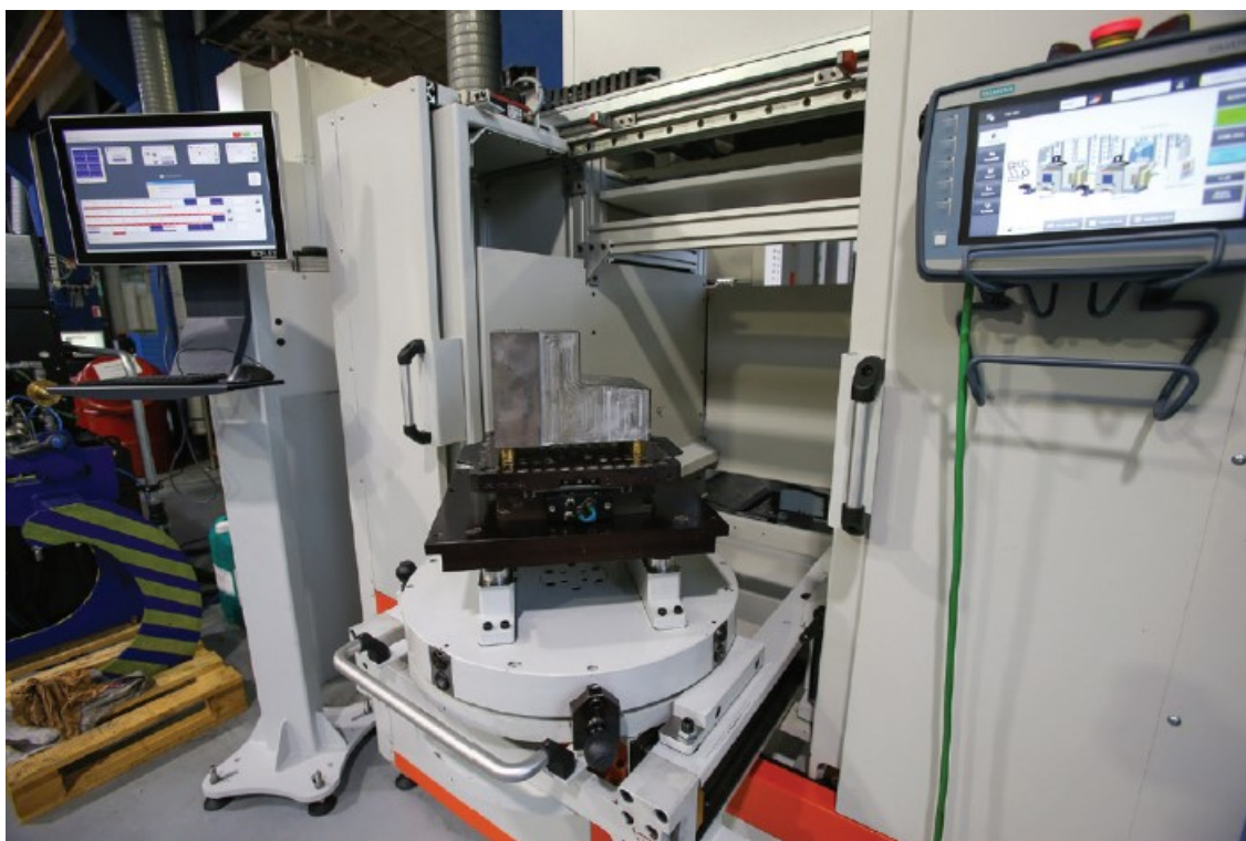
Slika 11. Automatizirana stanica za punjenje i pražnjenje FMS [9]
