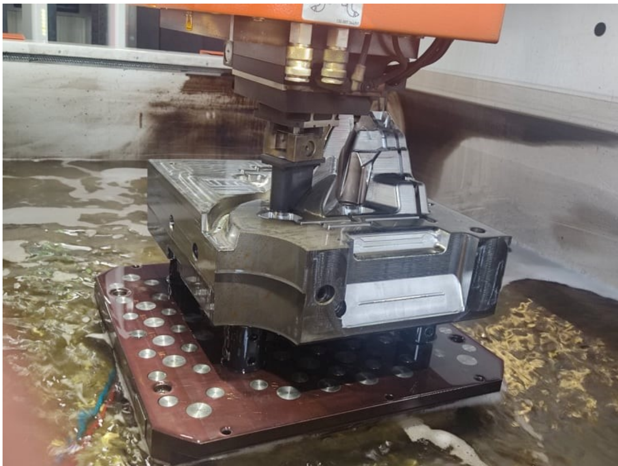
Slika 57. Izgled kalupnog uložka dok dielektrična tekućina istječe
