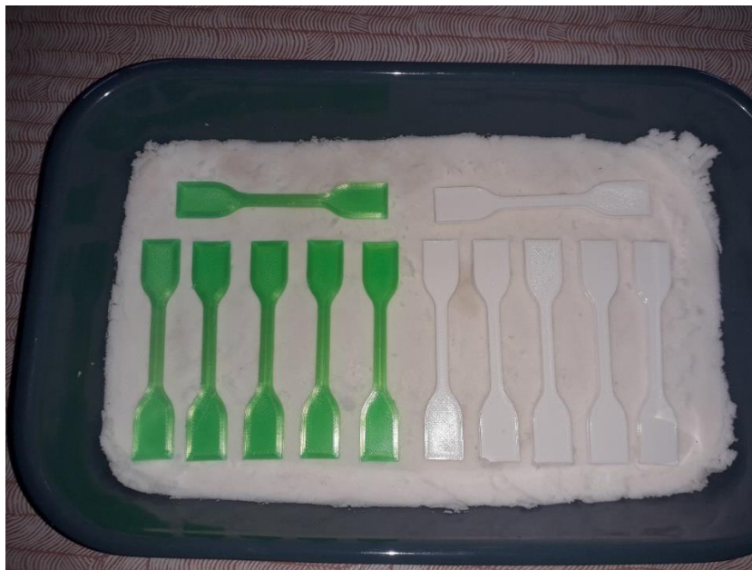
Slika 5.9. Raspored epruveta u posudi za žarenje
