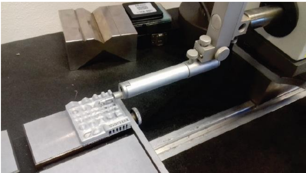
Slika 3.12. Uređaj za mjerenje površinske hrapavosti [10]
