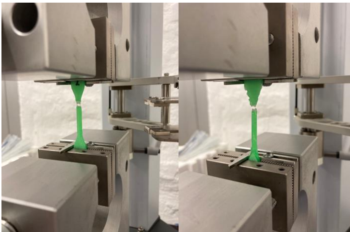
Slika 5.33. Lom epruveta od PETG žarenih pri 160°C (lijevo) i 170°C (desno)
