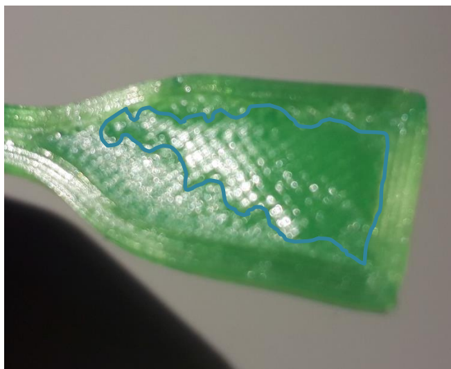
Slika 5.15. Mjehurići na površini epruvete od PETG
