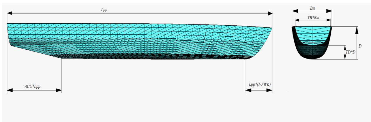
**Slika 6. Parametri glavnih i karakterističnih dimenzija analitičke forme**
