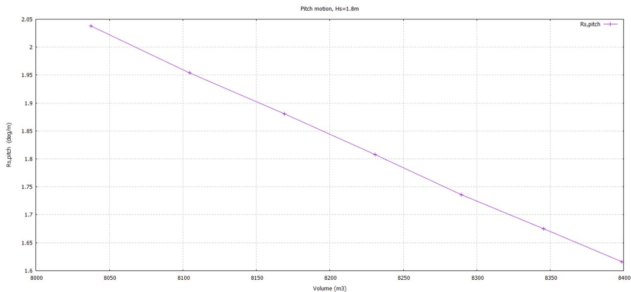
Slika 37. Utjecaj punoće gl. rebra  $MS_{full}$  na posrtanje  $R_{S,\eta5}$  u odnosu na volumen istisnine  $V$  (m<sup>3</sup>)
