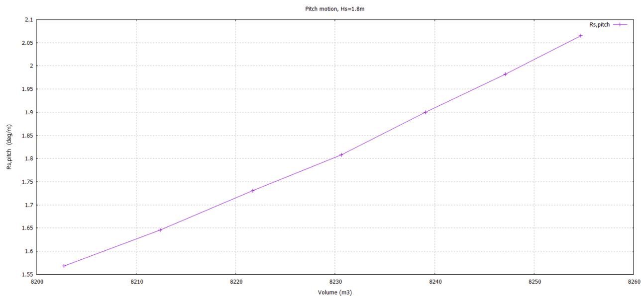
Slika 49. Utjecaj punoće zrcala  $TR_{full}$  na posrtanje  $R_{S,\eta5}$  u odnosu na volumen istisnine  $V$  (m<sup>3</sup>)
