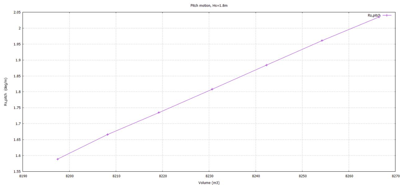
Slika 55. Utjecaj punoće pramca  $FWD_{full}$  na posrtanje  $R_{S,\eta5}$  u odnosu na volumen istisnine  $V$  (m<sup>3</sup>)
