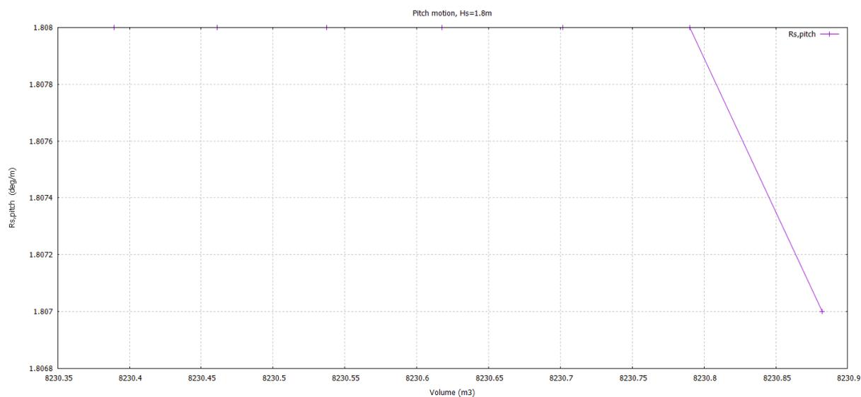
Slika 43. Utjecaj punoće krme  $AFT_{full}$  na posrtanje  $R_{S,\eta_5}$  u odnosu na volumen istisnine  $V$  (m<sup>3</sup>)
