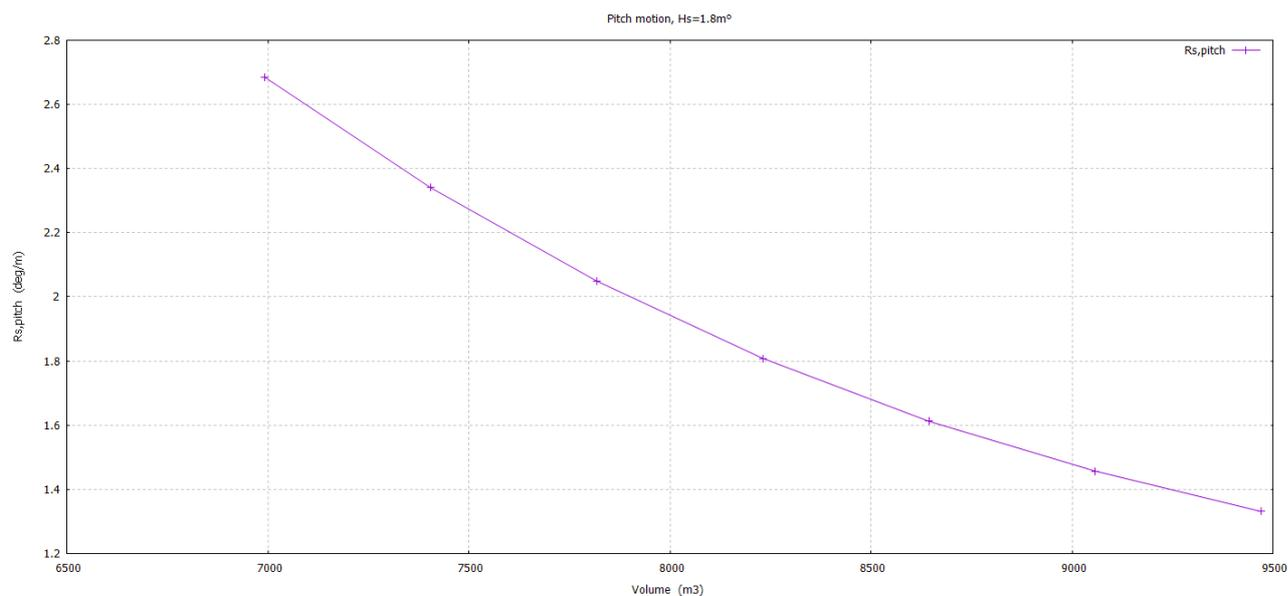
Slika 19. Utjecaj duljine na posrtanje  $R_{S,\eta5}$  u odnosu na volumenu istisnine  $V$  (m<sup>3</sup>)
