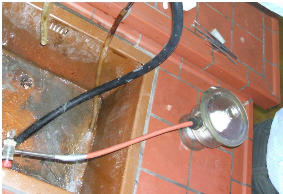
*Slika 3.3. Uklanjanje mjehurića zraka u eksikatoru.*
