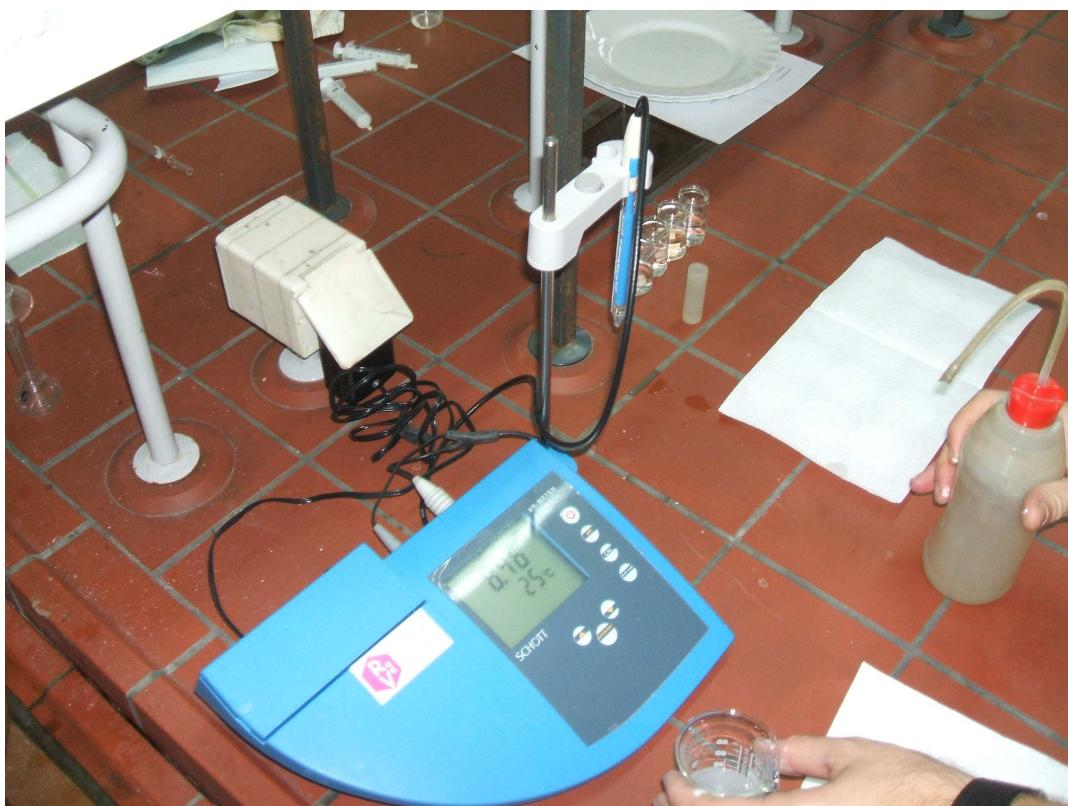
*Slika 3.5. Mjerenje pH vrijednosti suspenzije.*
