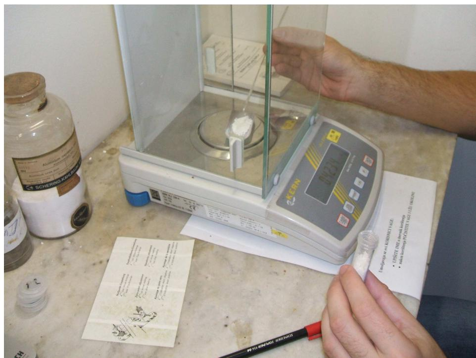
*Slika 3.1. Određivanje masenog udjela pojedinih elemenata u suspenziji.*
