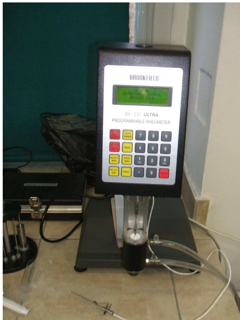
*Slika 3.6. Rotacijski viskozimetar (Brookfield DV-III Ultra, U.S.A.).*
