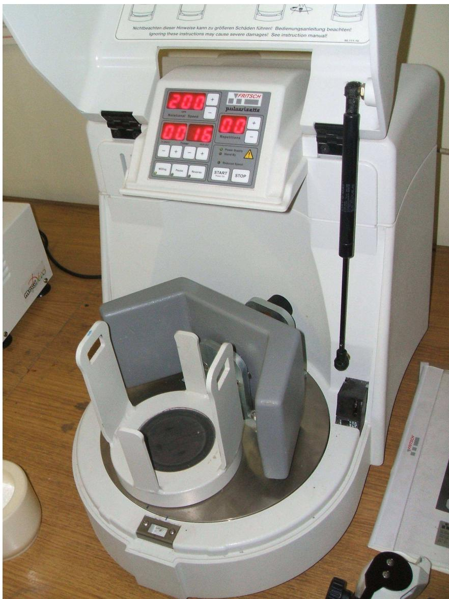
*Slika 3.2. Planetarni kuglični mlin (Pulverisette 6, Fritsch, Germany).*
