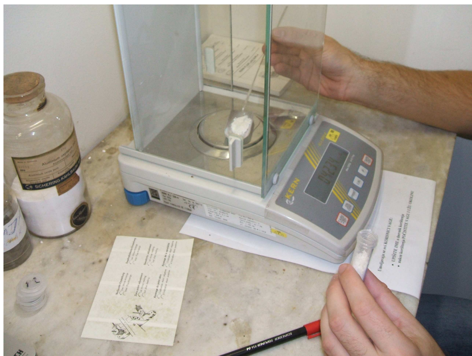
Slika 3.1. Određivanje masenog udjela pojedinih elemenata u suspenziji.
