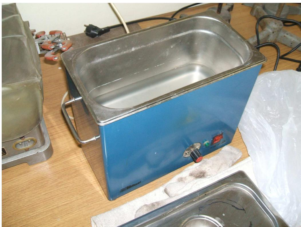
*Slika 3.4. Uklanjanje mjehurića zraka u ultrazvučnoj kupelji.*
