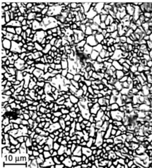
Slika 2.1. Mikrostruktura sitnozrnate aluminij oksidne keramike [19].
