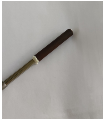
Slika 29. PT 100 sonda montirana u modificirani svornjak
