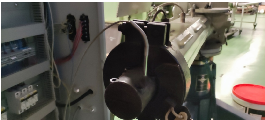
Slika 30. PT 100 sonda montirana u alat ekstrudera
