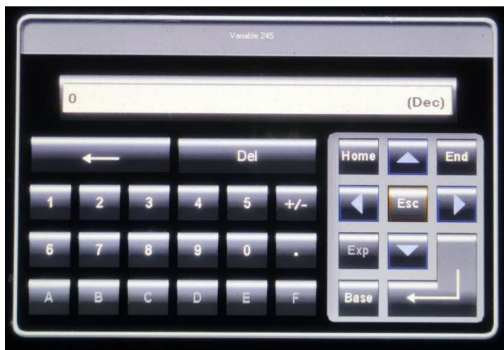
Slika 50. Iskakajuća tipkovnica na zaslonu PLC uređaja
