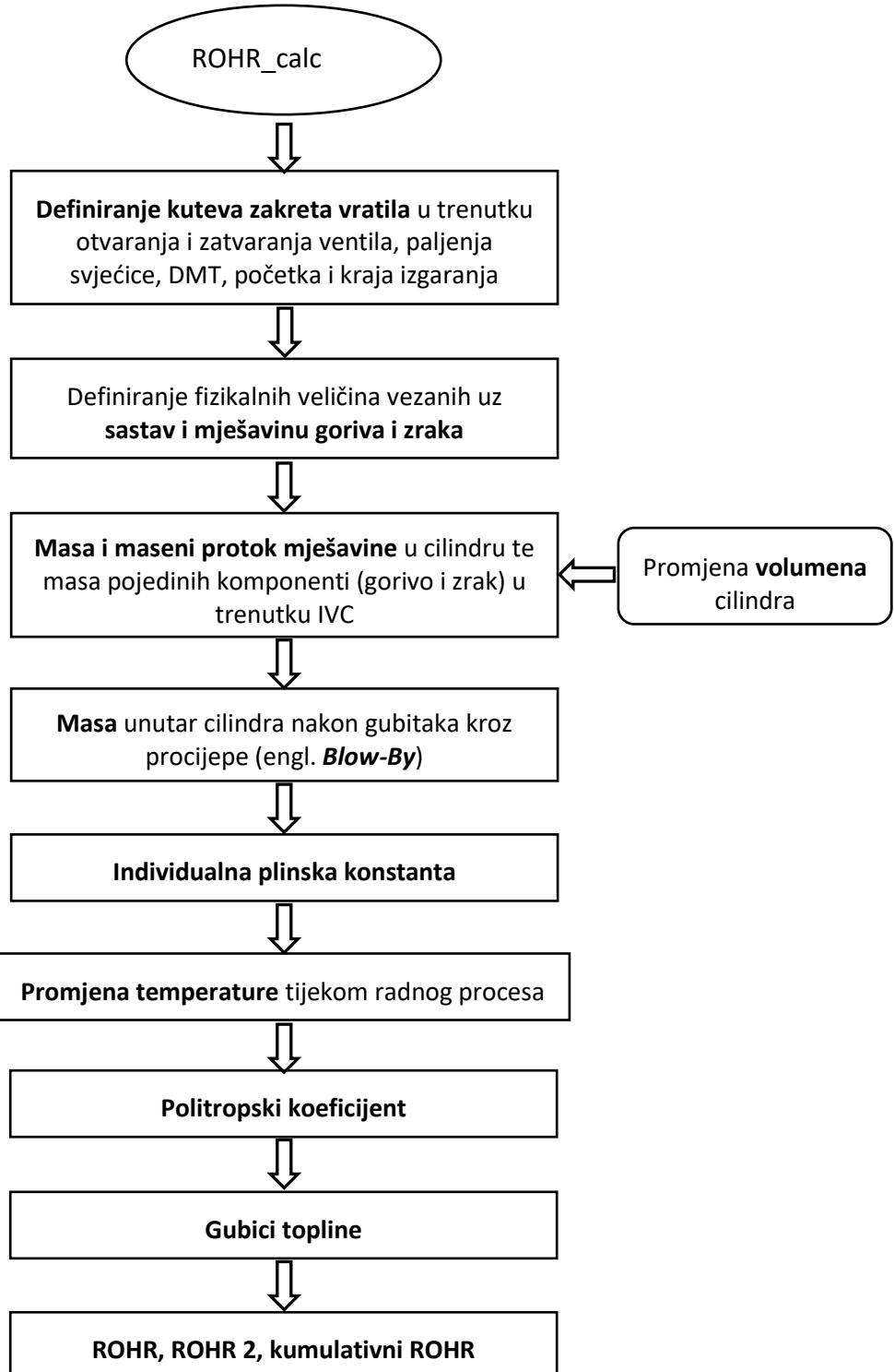
Slika 15. Dijagram toka ROHR analize
