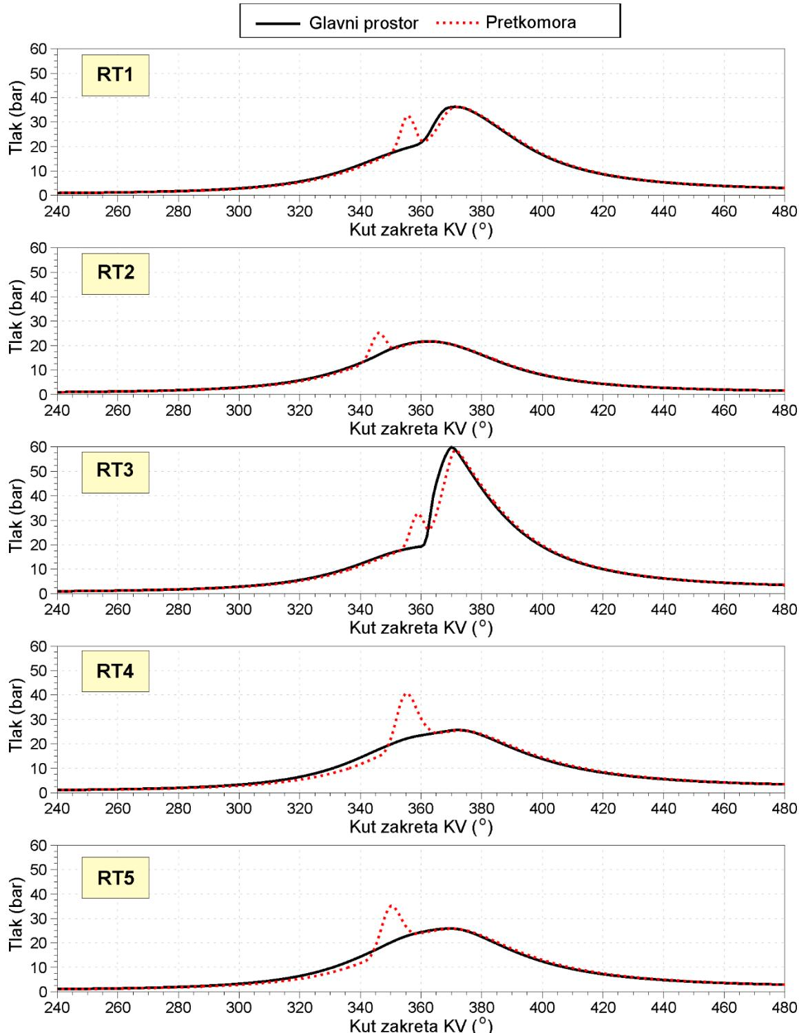
Slika 18. Profili tlaka u pretkomori i glavnem prostoru izgaranja za svih 5 radnih točaka
