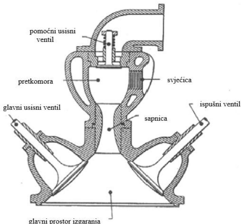
*Slika 1. Presjek cilindra prvog dvotaktnog motora s pretkomorom Ricarda Dolphina [7]*
