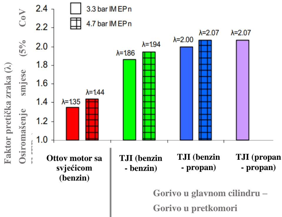
*Slika 11. Usporedba faktora pretička zraka ( $\lambda$ ) konvencionalnog Ottovog motora te TJI motora s benzином, propanom i kombinacije benzина i propana u pretkomori i glavnom prostoru izgaranja [13]*
