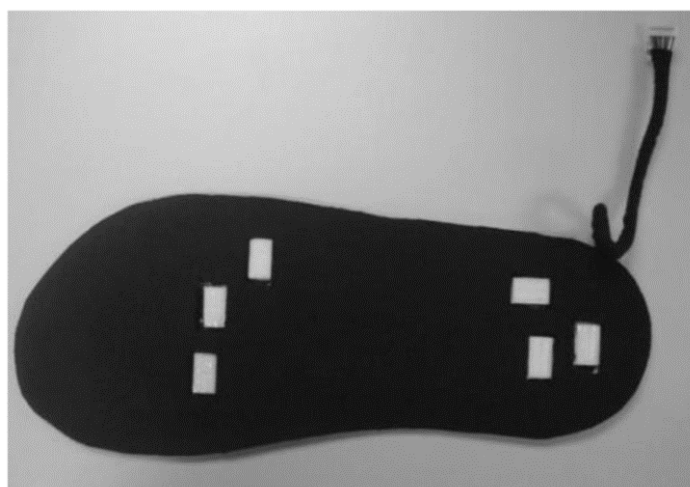
Slika 17. 6 senzora tlaka u ulošku [13]
