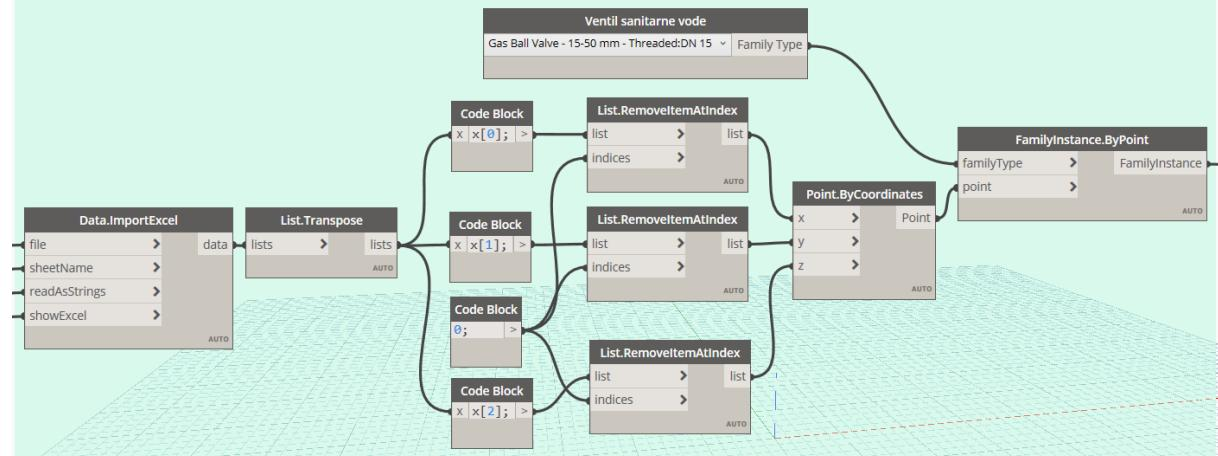
Slika 33. Algoritam za razvrstavanje geometrijskih karakteristika ventila
