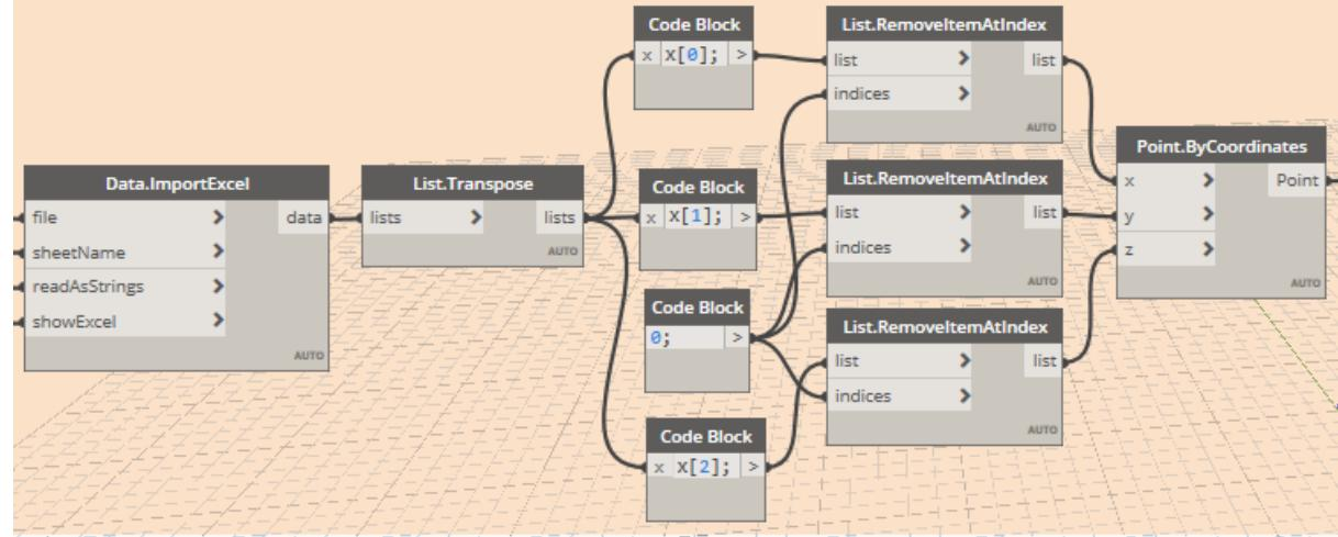
**Slika 32. Algoritam za razvrstavanje krajnjih točki cijevi**
