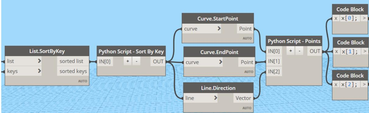
Slika 18. Algoritam za sortiranje strojarskih cijevi po udaljenosti
