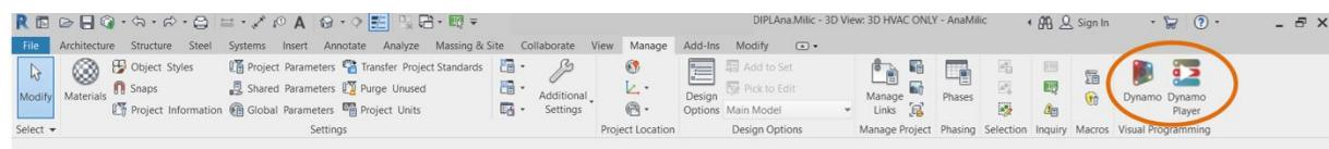
Slika 13. Prikaz Dynama i Dynamo Playera unutar alatne trake Revita
