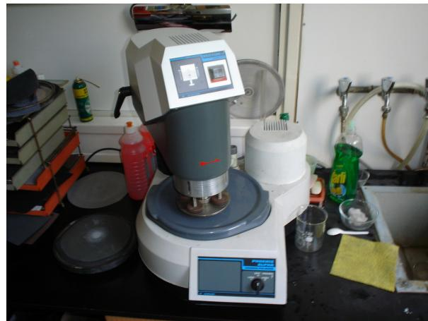
*Slika 24. Uređaj za poliranje Buehler.*
