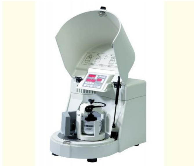
*Slika 18. Uređaj za homogenizaciju praha Pulverisette 6, Frisch*
