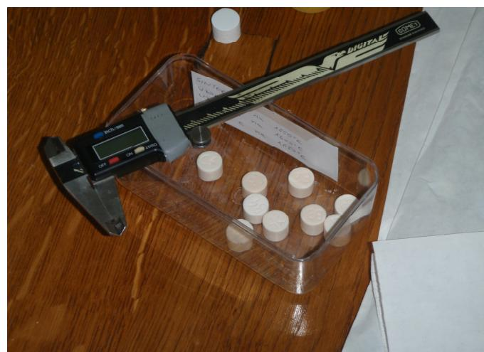
*Slika 20. Pomična mjerka korištena za određivanje dimenzija uzoraka.*
