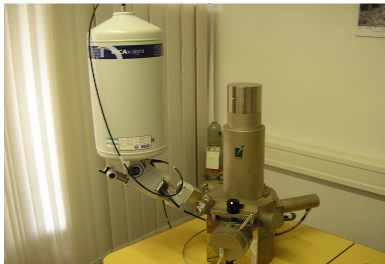
*Slika 26. Pretražni elektronski mikroskop Tescan Vega TS5136LS.*
